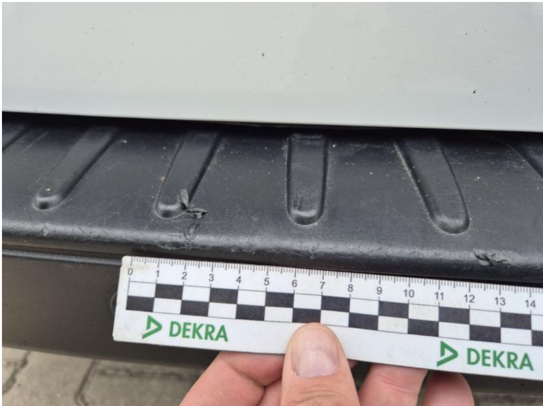
Fot. 45 Zderzak tylny cz górna - Rysa/odprysk 2
