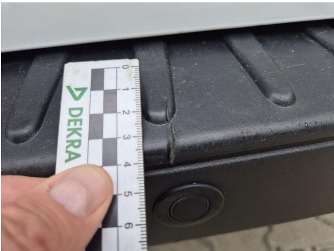
Fot. 46 Zderzak tylny cz górna() - Rysa/odprysk 3
