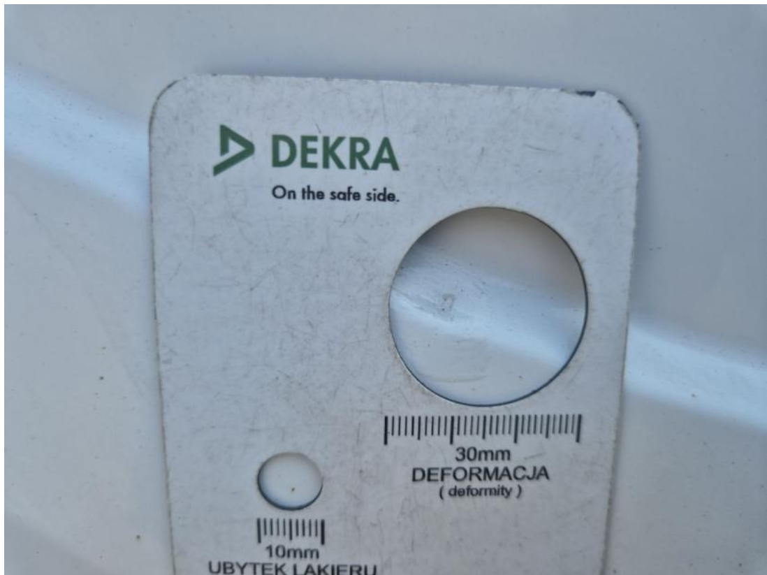
Fot. 79 Drzwi tyłu lewe - Wgniecenie/odkształcenie 1
