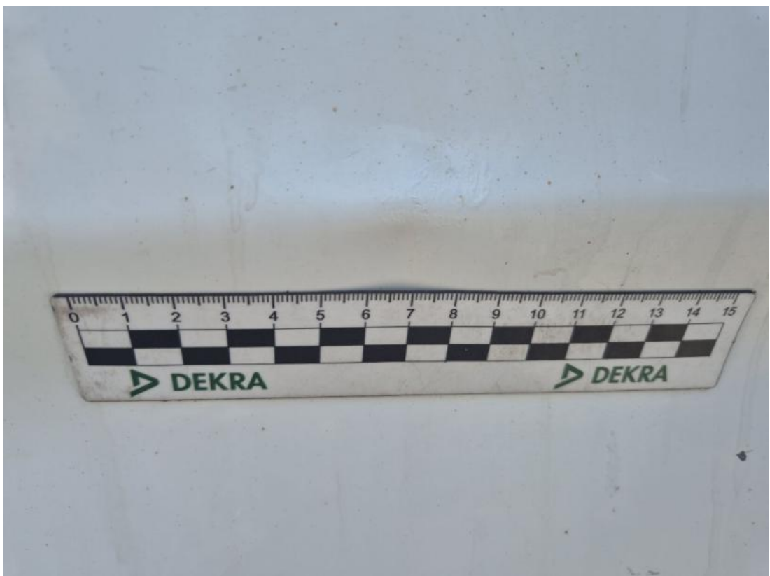
Fot. 86 Drzwi tyłu prawe - Wgniecenie/odkształcenie 1
