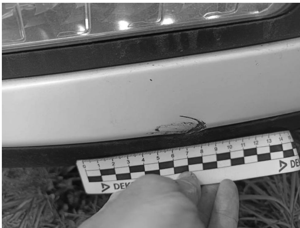
Fot. 39. Zderzak - Rysa/odprysk 2
