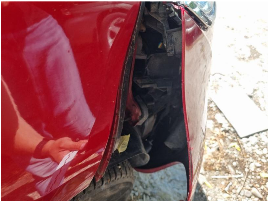
Fot. 62 Zderzak - Pęknięcie/rozerwanie 1
