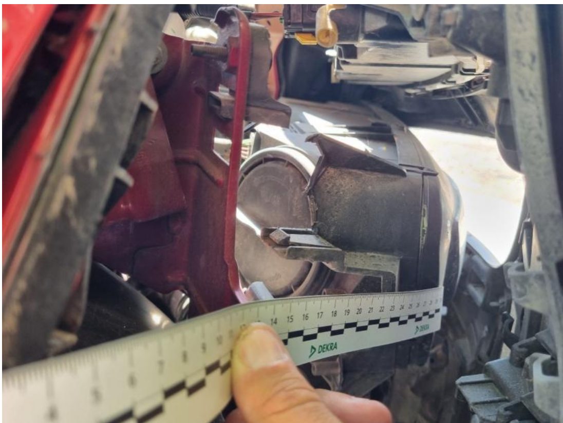
Fot. 74 Reflektor P - Pęknięcie/rozerwanie 1
