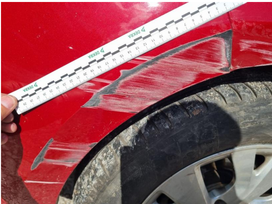
Fot. 66 Zderzak przedni cz L - Rysa/odprysk 1
