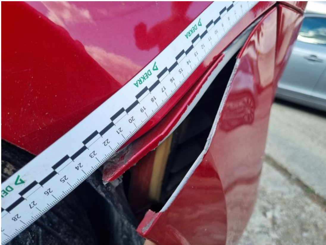
Fot. 97 Zderzak tylny cz L - Pęknięcie/rozerwanie 1
