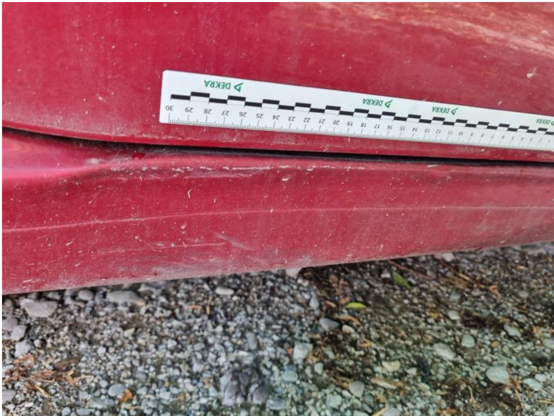
Fot. 85 Próg P() - Wgniecenie/odkształcenie 3
