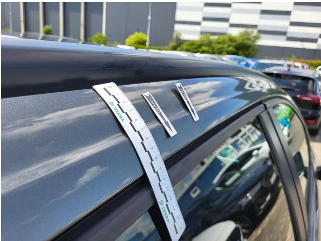
Fot. 54 Rama dachu P - Wgniecenie/odkształcenie 1
