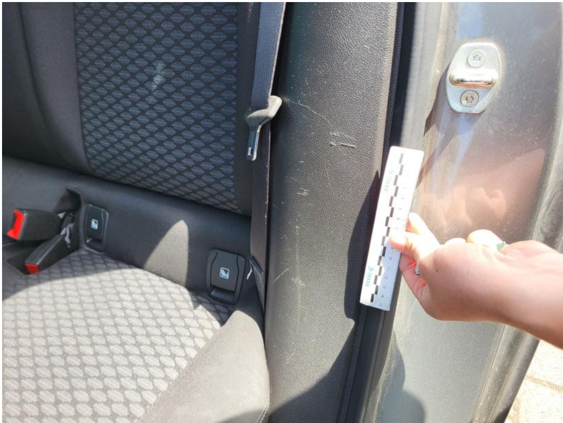
Fot. 65 Wykładzina(y) słupka tylnego L - Rysa/odprysk 1
