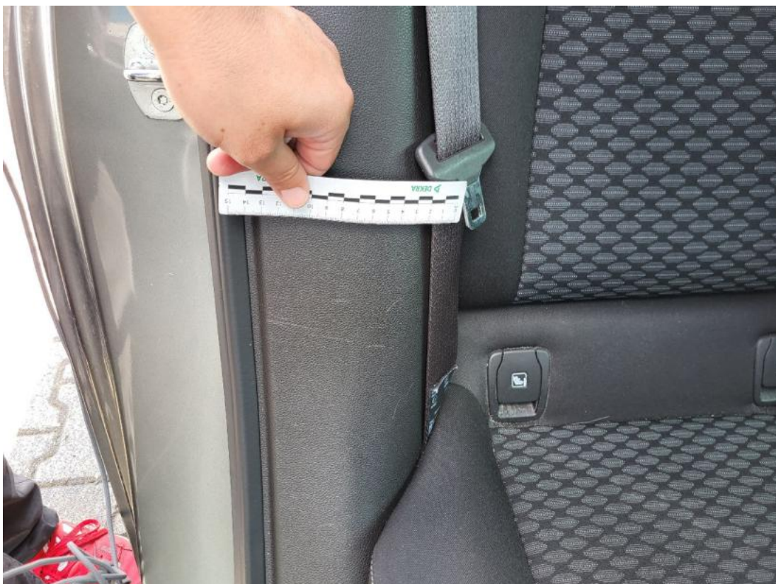
Fot. 66 Wykładzina(y) słupka tylnego P - Rysa/odprysk 1
