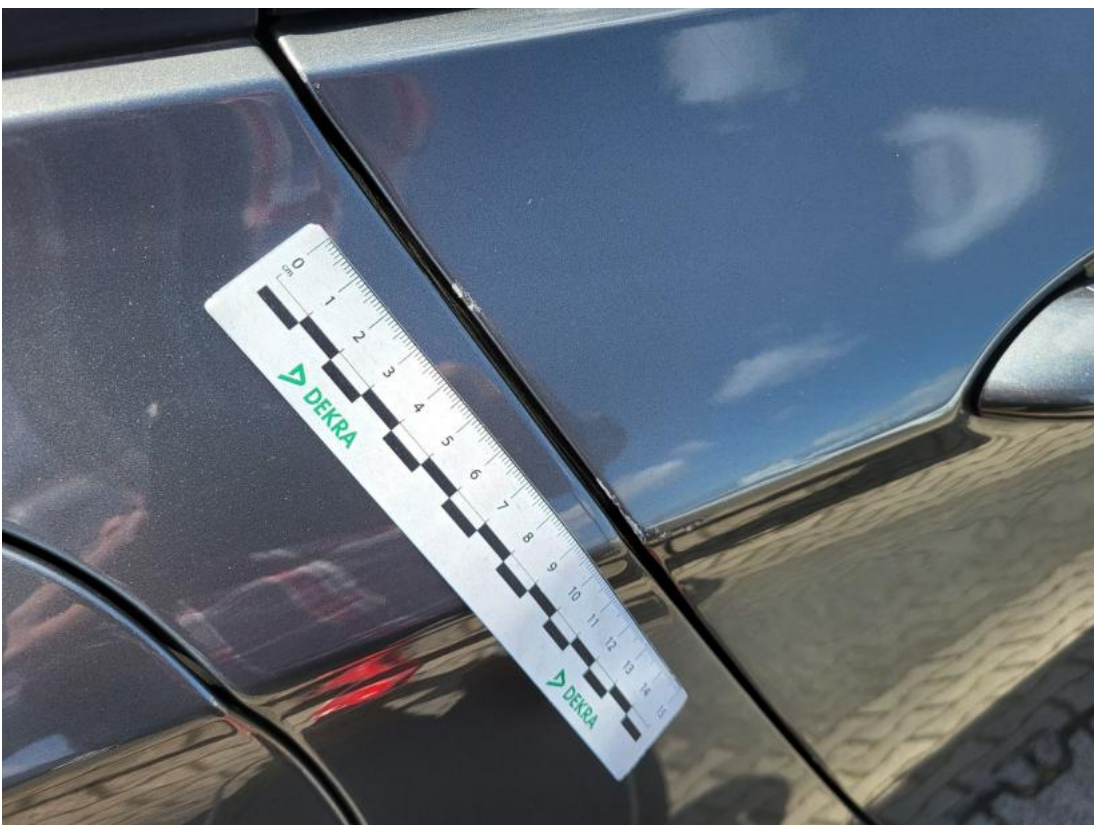
Fot. 48 Drzwi tylne P - Rysa/odprysk 1
