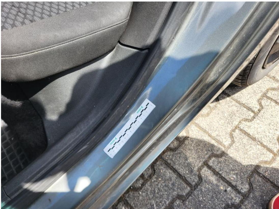
Fot. 60 Próg L - Rysa/odprysk 1
