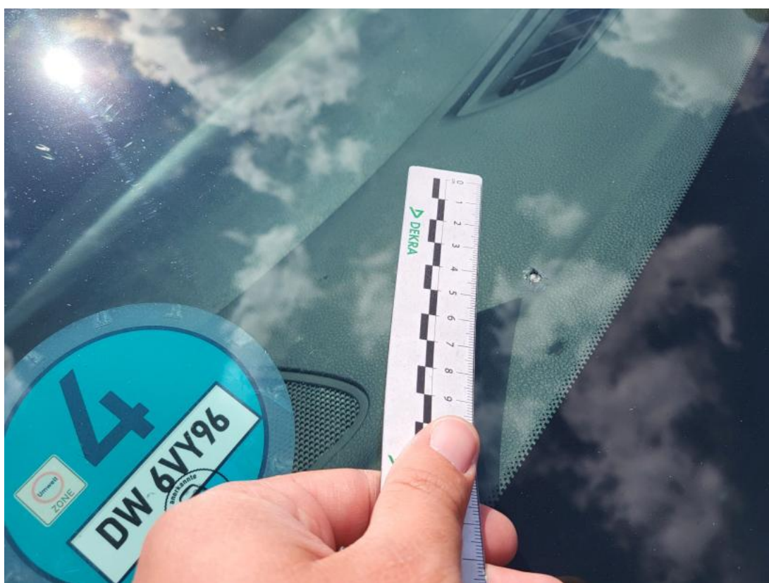
Fot. 42 Szyba czołowa - Rysa/odprysk 1
