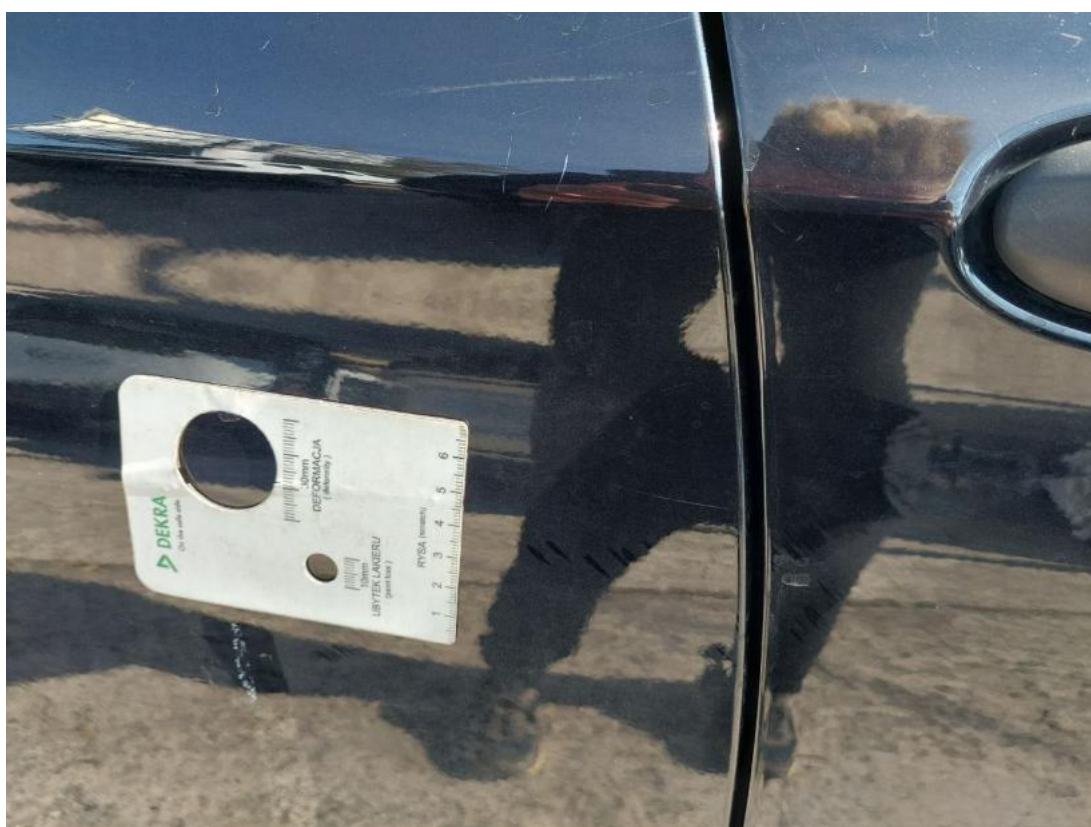
Fot. 46 Drzwi tylne P - Rysa/odprysk 2
