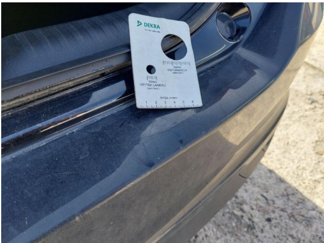
Fot. 48 Zderzak tylny cz górna - Pęknięcie/rozerwanie 1
