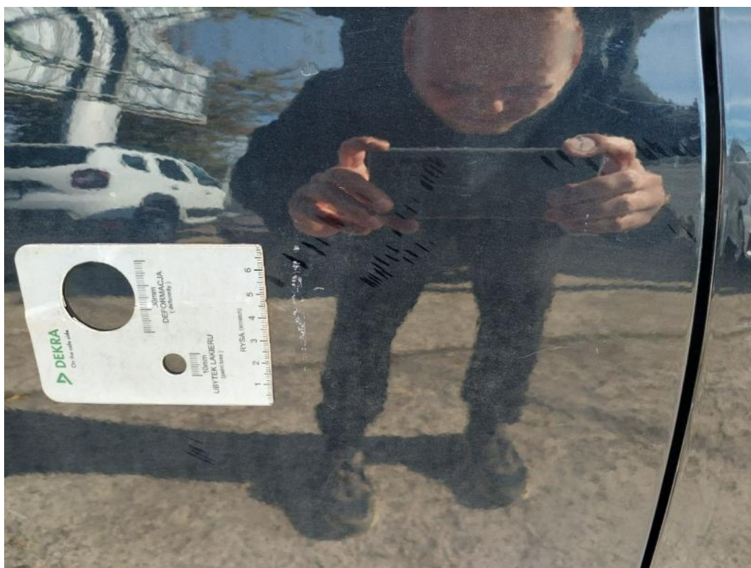
Fot. 45 Drzwi tylne P - Rysa/odprysk 1
