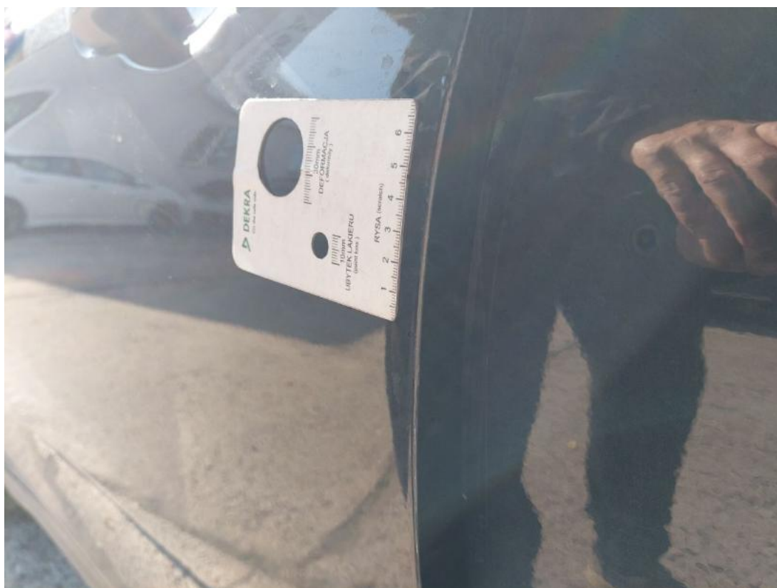
Fot. 51 Drzwi przed L - Rysa/odprysk 1
