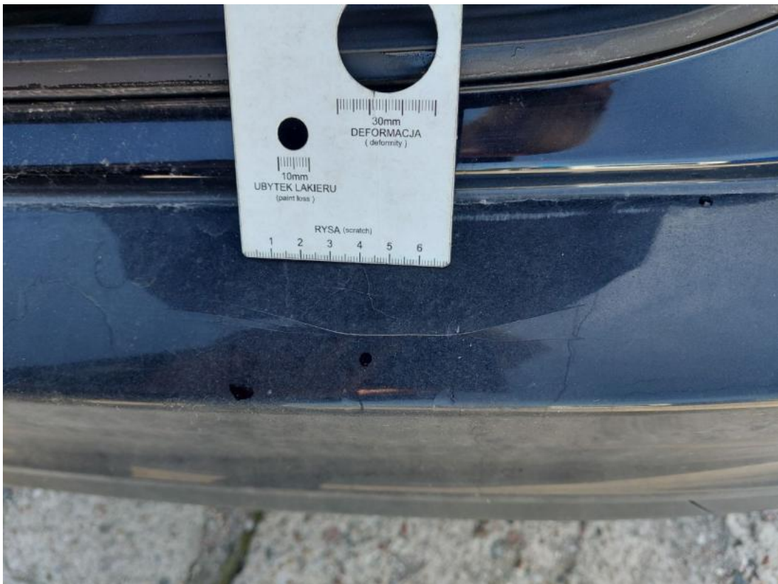
Fot. 47 Zderzak tylny cz górna - Rysa/odprysk 1
