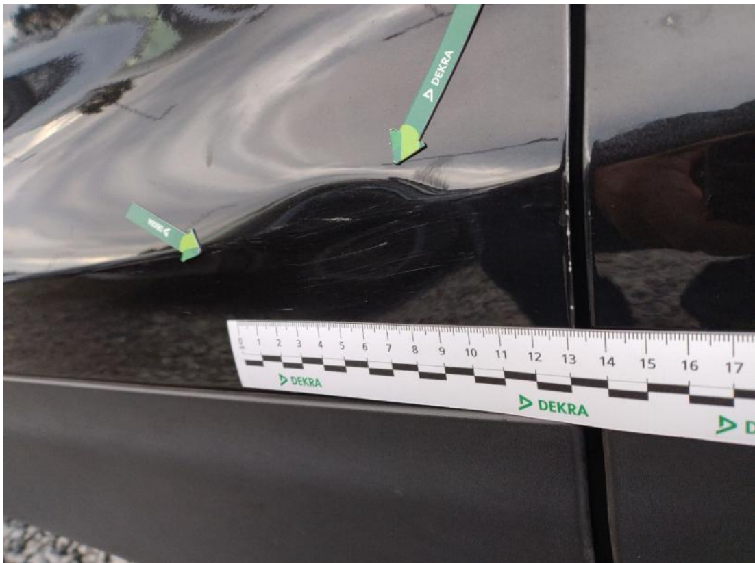
Fot. 61 Drzwi przed L - Wgniecenie/odkształcenie 1
