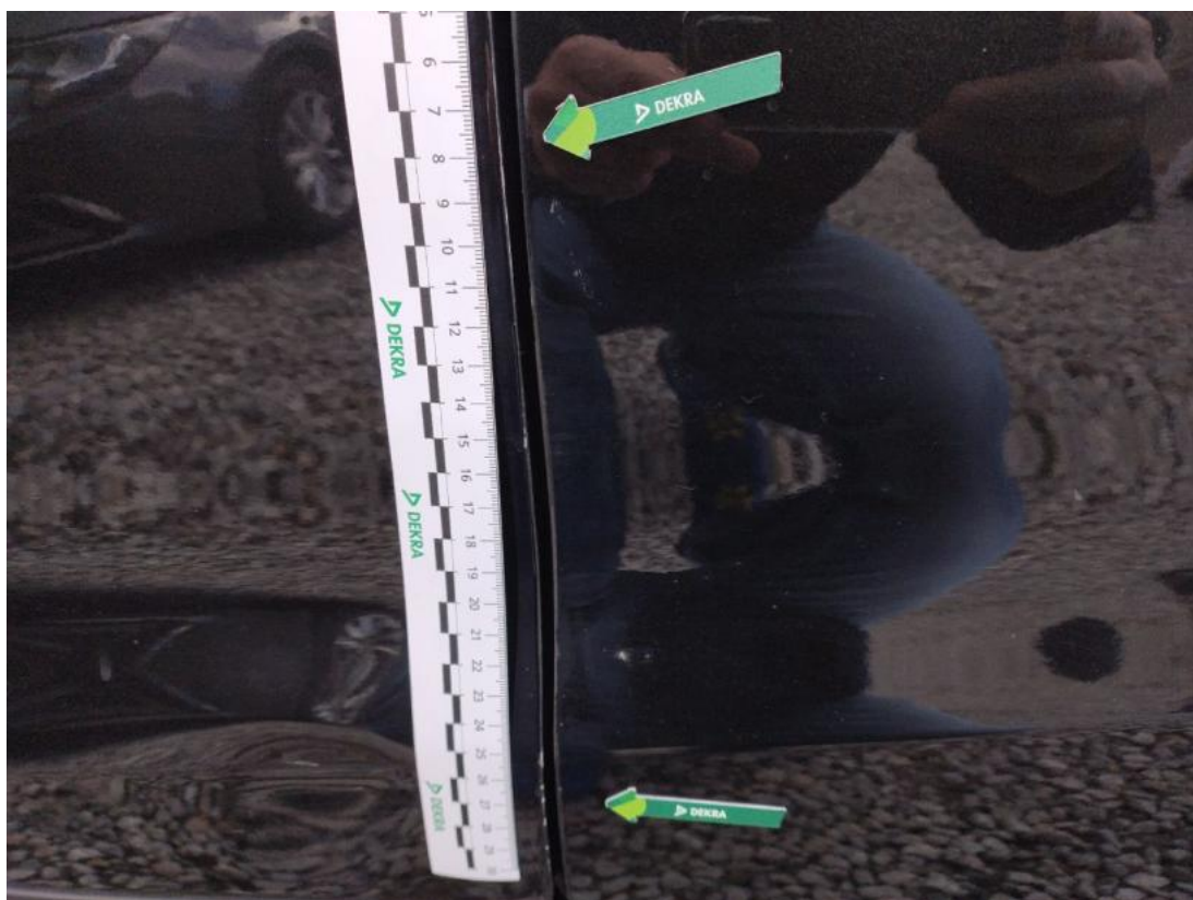
Fot. 59 Drzwi przed L - Rysa/odprysk 1
