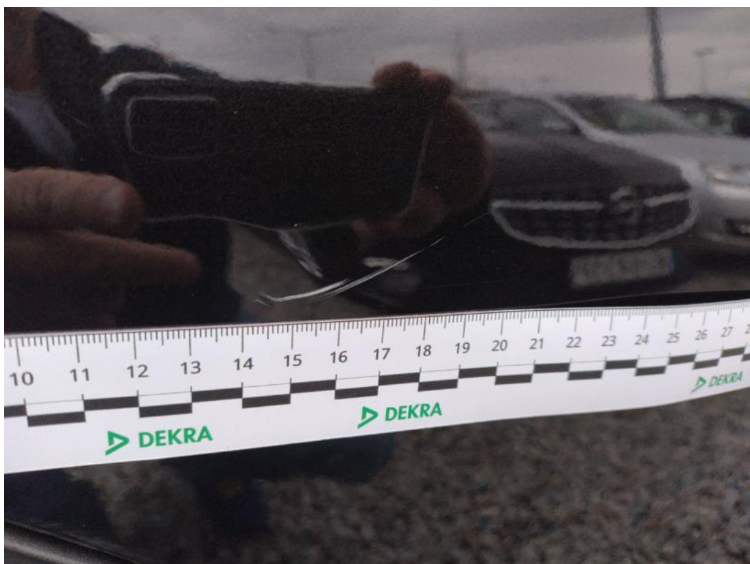
Fot. 49 Drzwi tylne P - Rysa/odprysk 1
