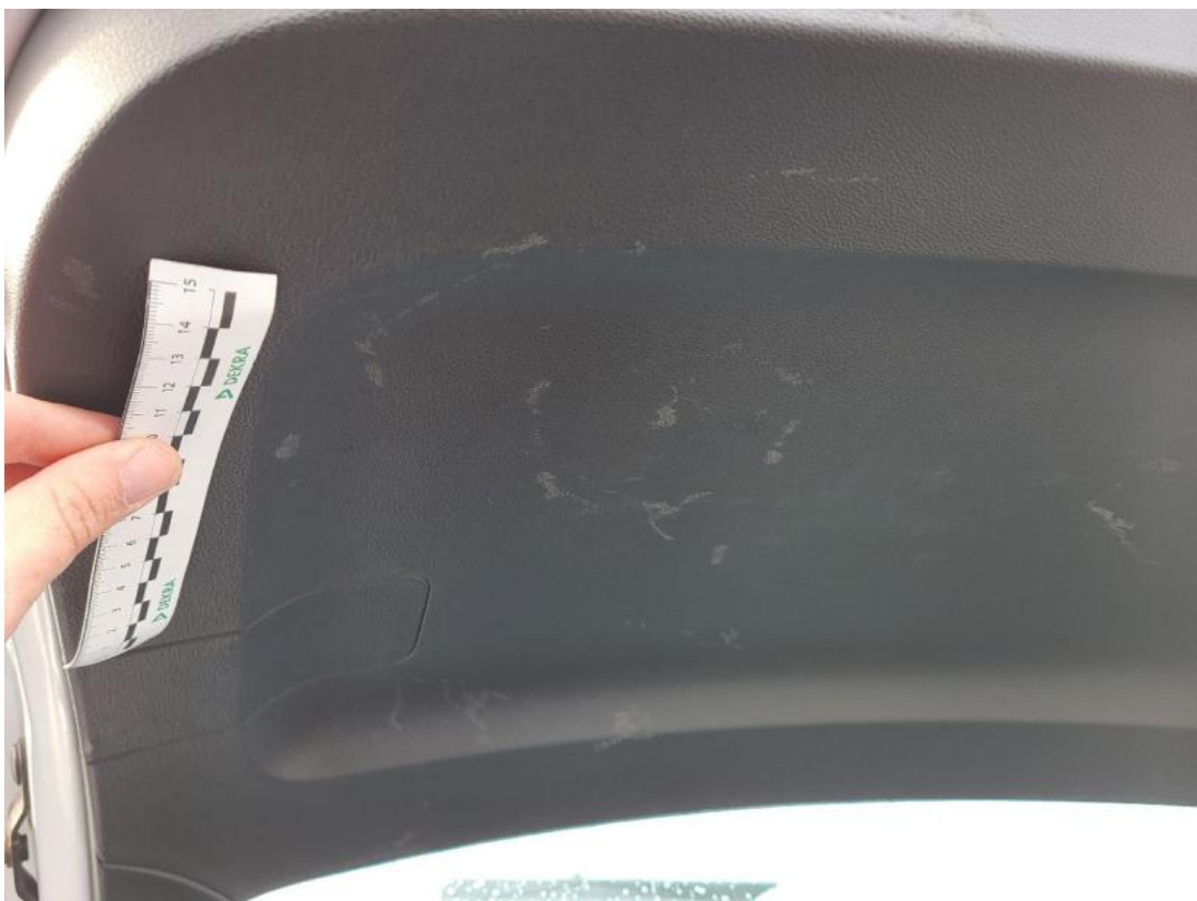
Fot. 44 Wykładzina pokrywy tylnej - Rysa/odprysk 1
