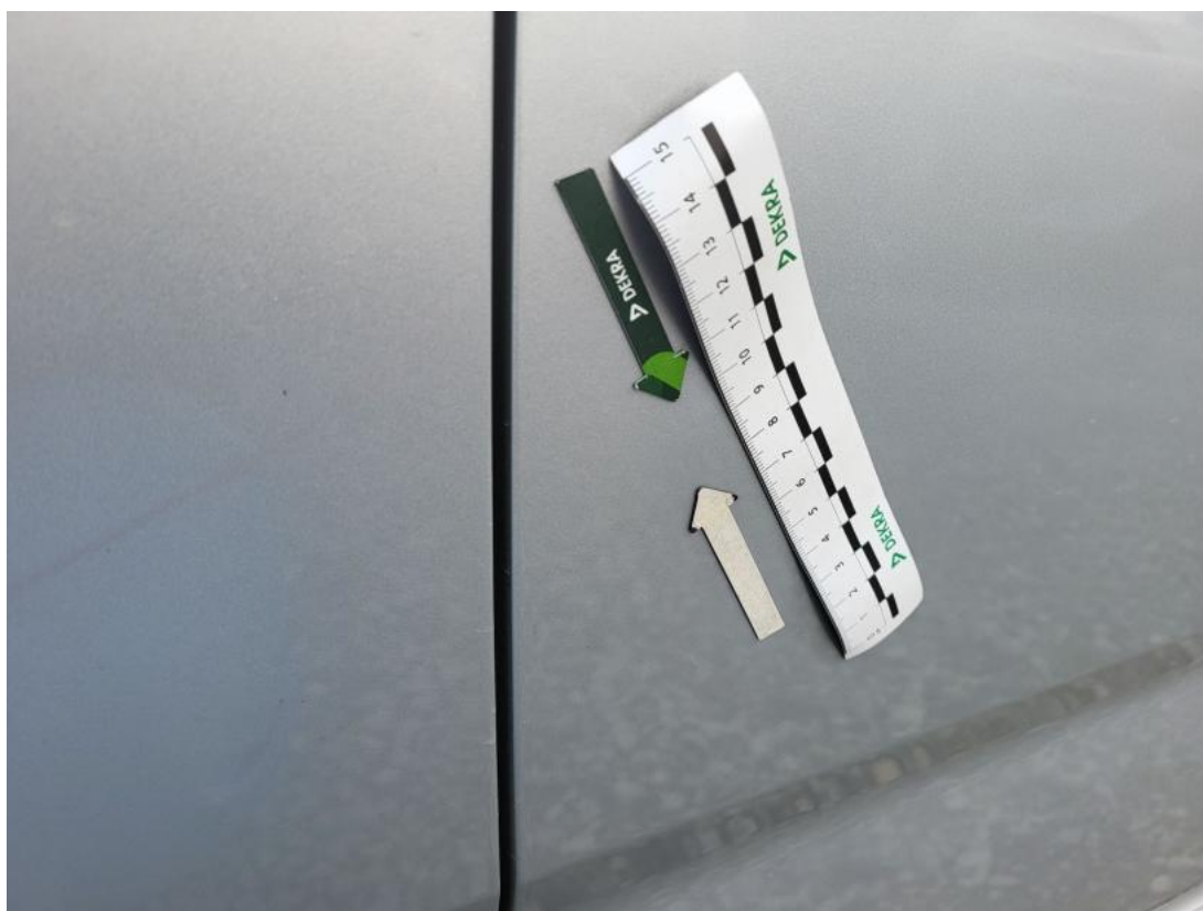
Fot. 41 Drzwi tylne L - Wgniecenie/odkształcenie 1
