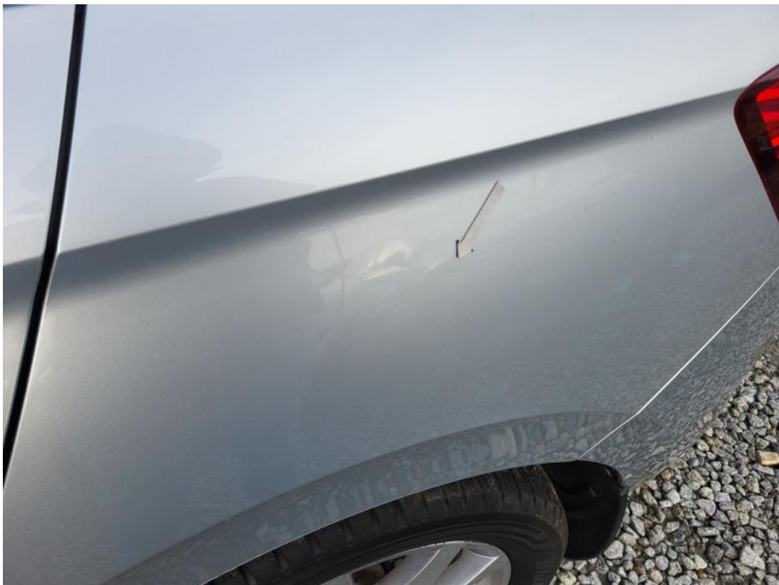
Fot. 38 Błotnik tylny L / Ściana boczna L - Wgniecenie/odkształcenie 1
