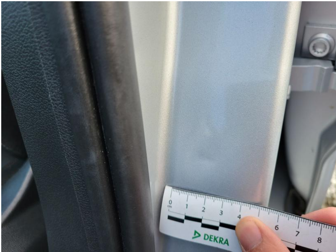
Fot. 43 Słupek środkowy L - Wgniecenie/odkształcenie 1
