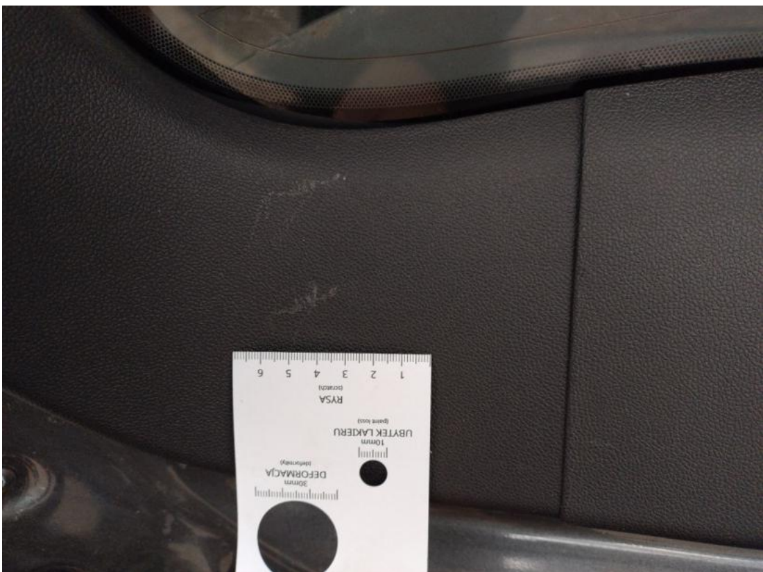
Fot. 62 Wykładzina pokrywy tylnej - Rysa/odprysk 2
