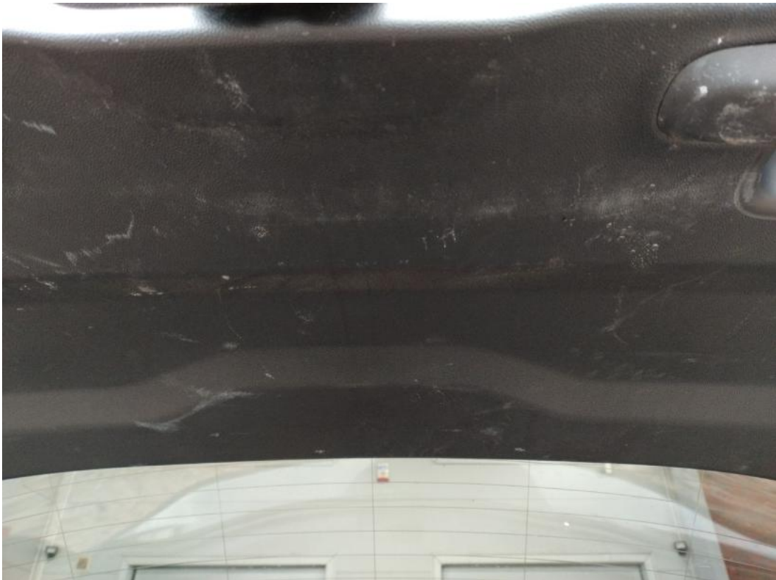
Fot. 61 Wykładzina pokrywy tylnej - Rysa/odprysk 1
