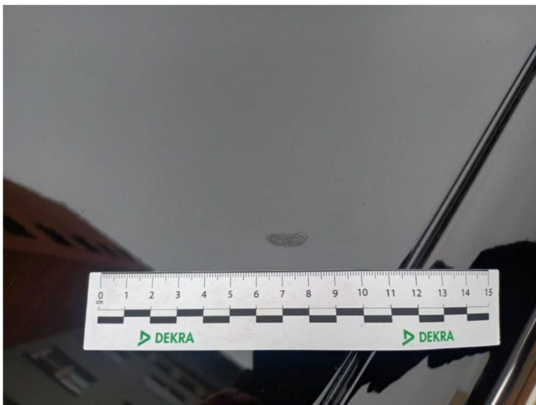
Fot. 45 Dach - Rysa/odprysk 2
