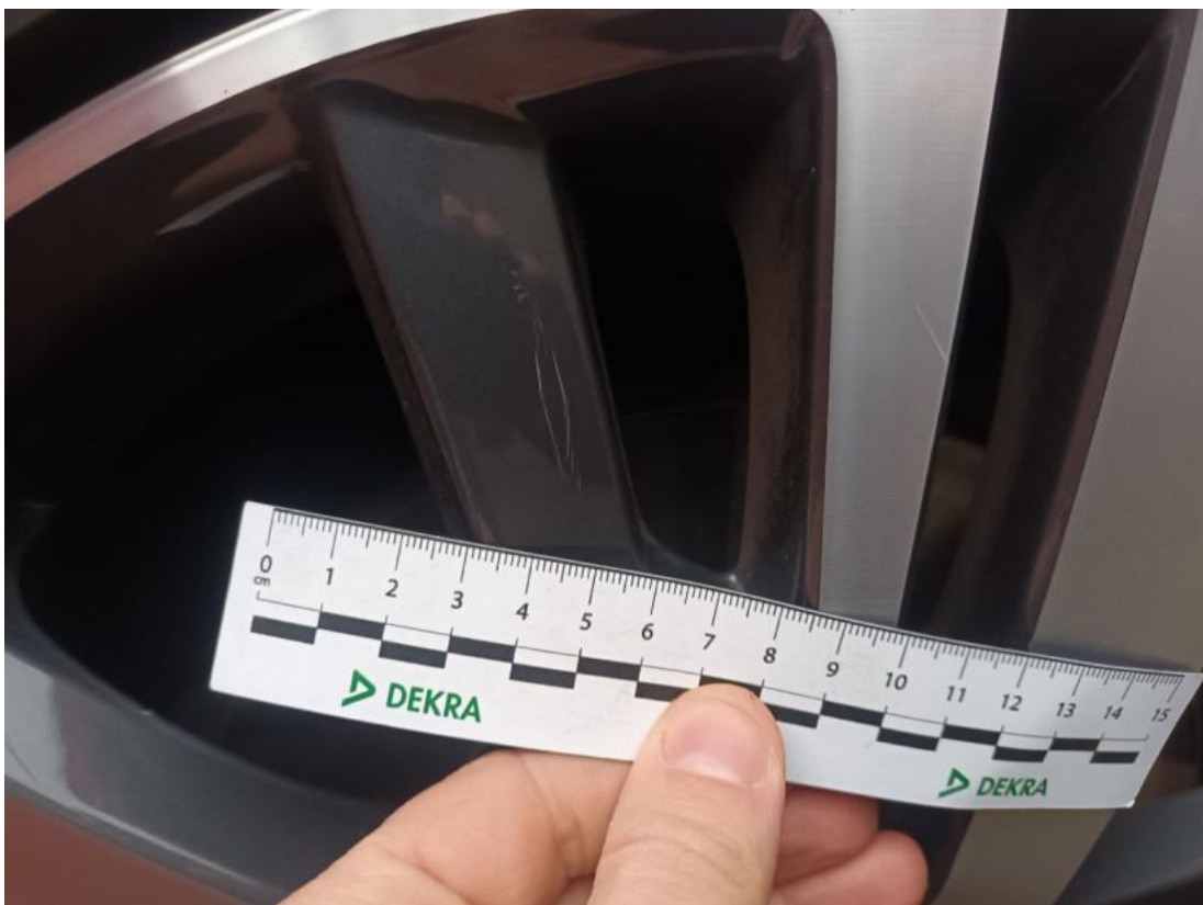
Fot. 40 Felga aluminiowa przednia P - Rysa/odprysk 1
