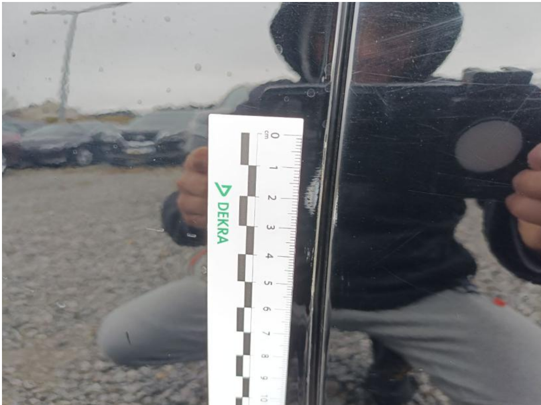
Fot. 49 Drzwi przed L - Rysa/odprysk 1
