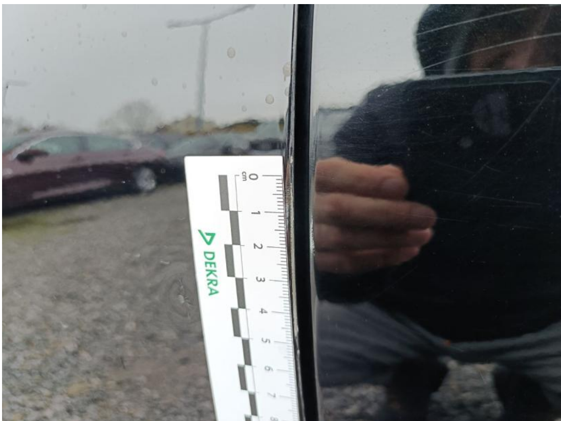
Fot. 50 Drzwi przed L - Rysa/odprysk 2
