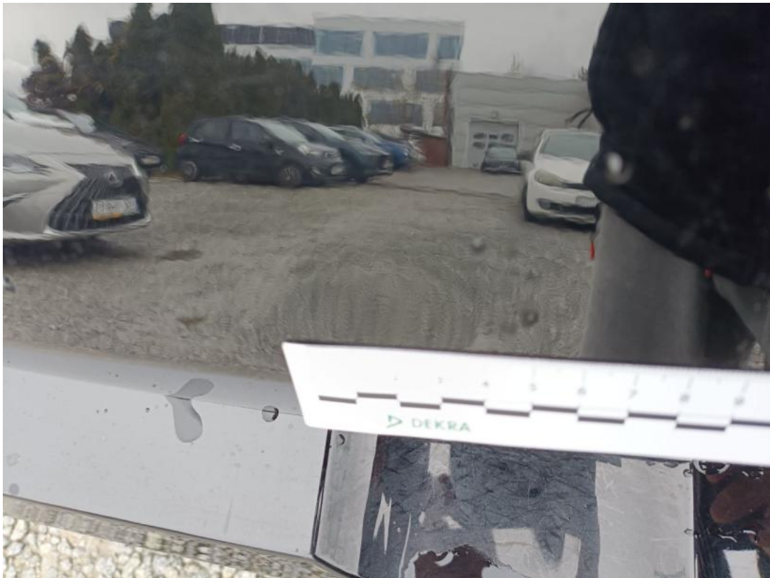
Fot. 45 Pokrywy bagażnika - Wgniecenie/odkształcenie 2
