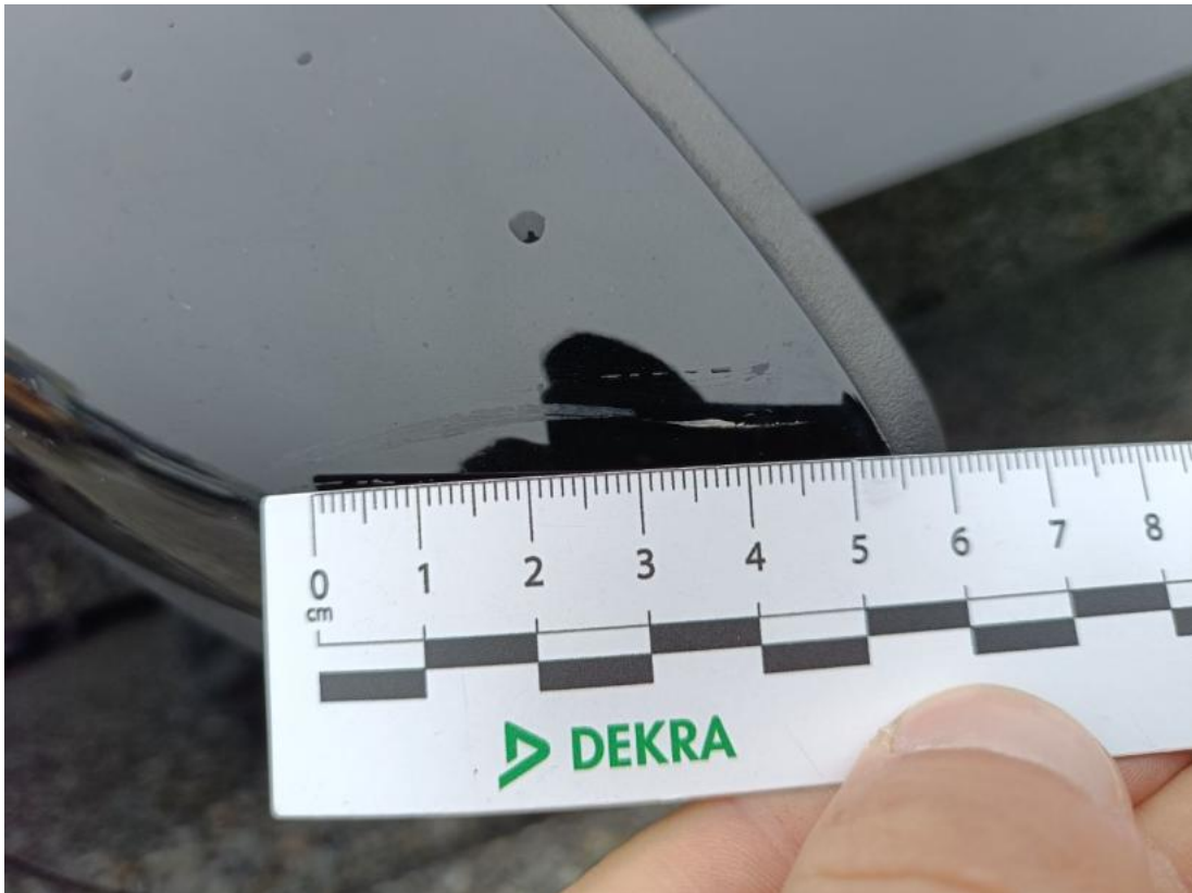
Fot. 61 Obudowa lusterka zew L - Rysa/odprysk 1
