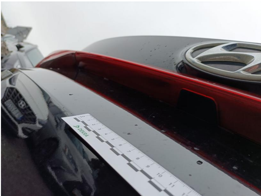
Fot. 46 Pokrywy bagażnika() - Wgniecenie/odkształcenie 3
