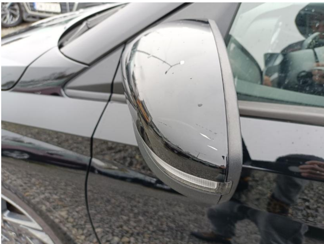
Fot. 62 Obudowa lusterka zew L - Rysa/odprysk 2
