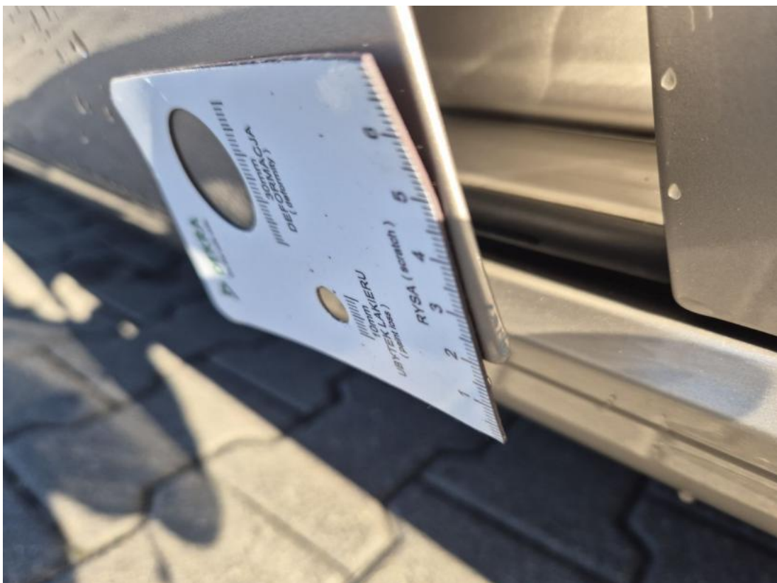
Fot. 52 Drzwi przed L - Rysa/odprysk 1
