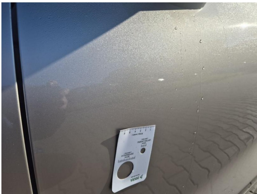
Fot. 54 Drzwi przed L() - Rysa/odprysk 3
