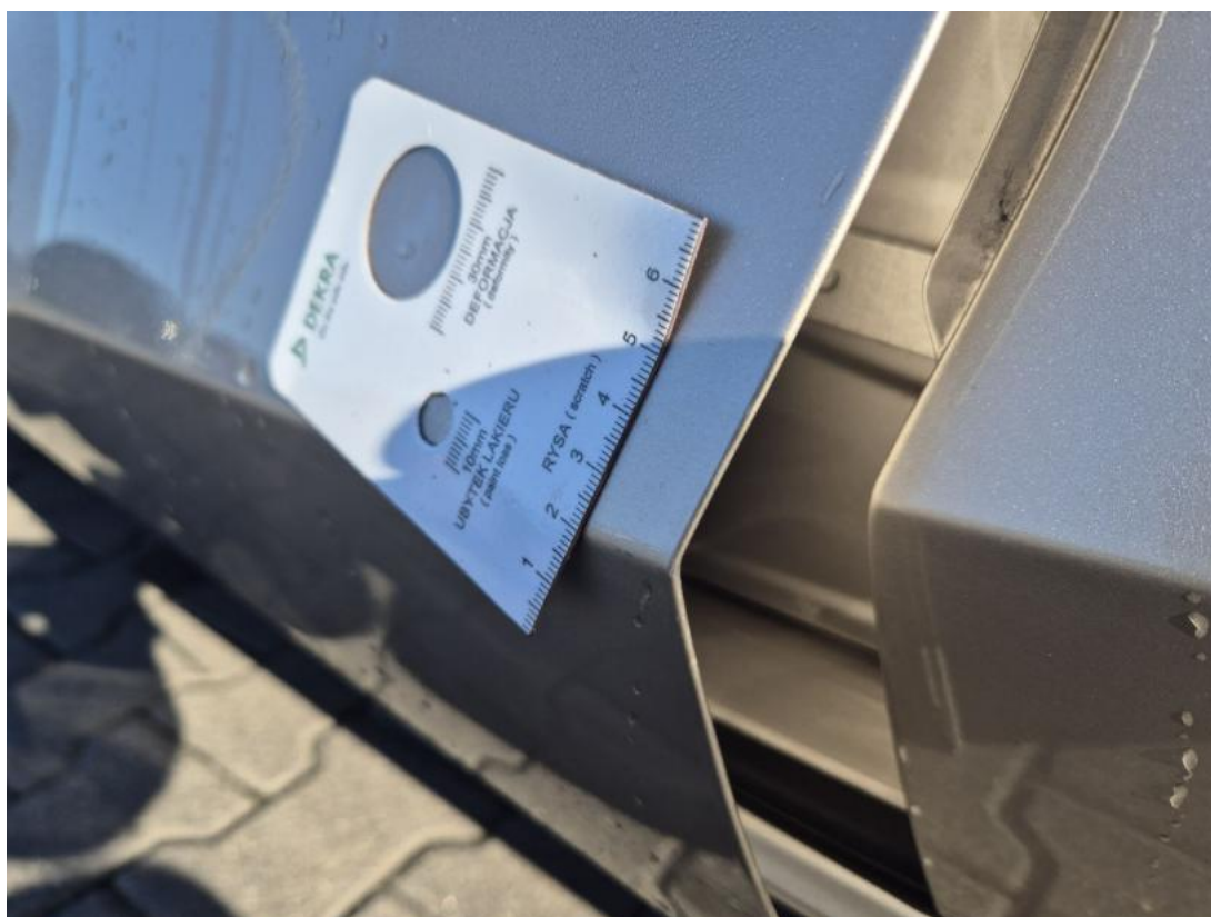
Fot. 53 Drzwi przed L - Rysa/odprysk 2
