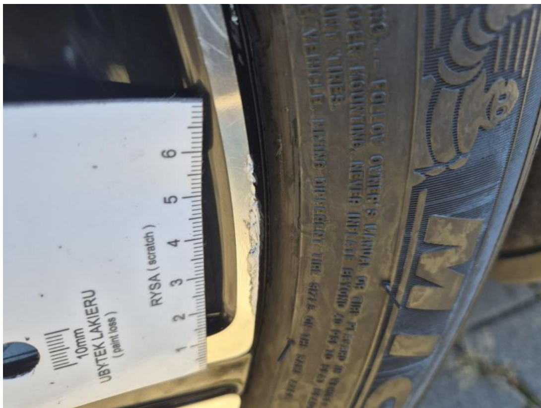
Fot. 47 Felga aluminiowa tylna P - Rysa/odprysk 1
