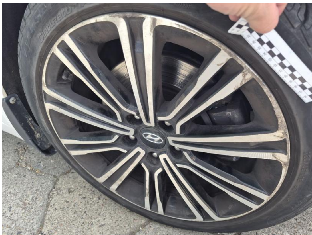
Fot. 40 Felga aluminiowa przednia P - Rysa/odprysk 1
