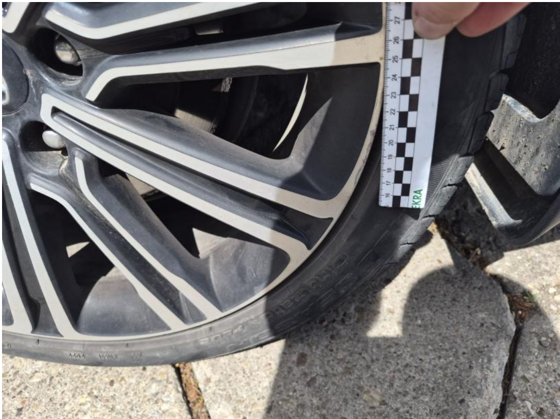
Fot. 53 Felga aluminiowa tylna L - Rysa/odprysk 1
