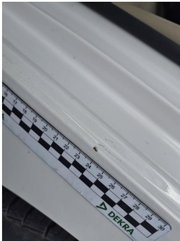
Fot. 52 Błotnik tylny L / Ściana boczna L - Rysa/odprysk 1
