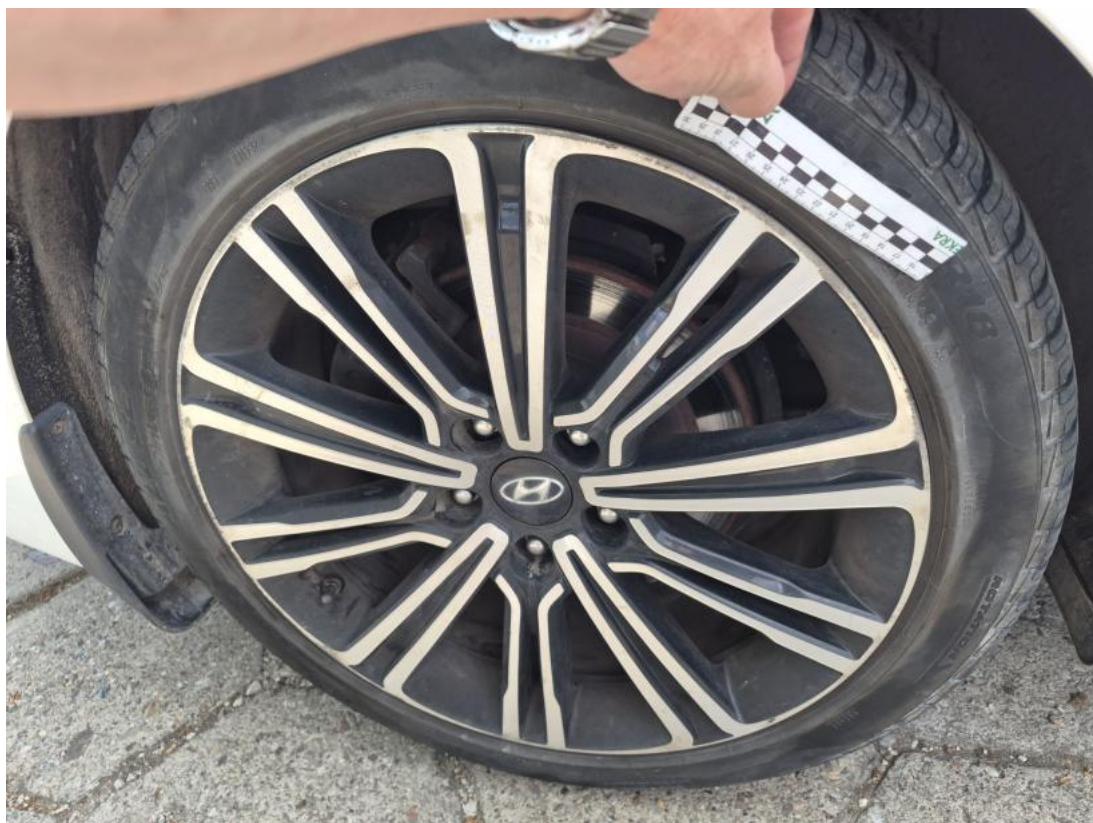
Fot. 45 Felga aluminiowa tylna P - Rysa/odprysk 1
