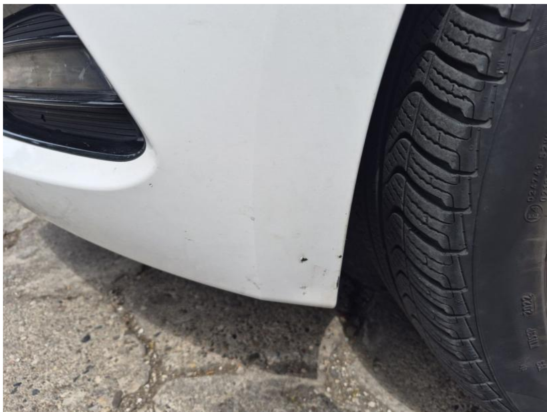
Fot. 39 Zderzak - Rysa/odprysk 1
