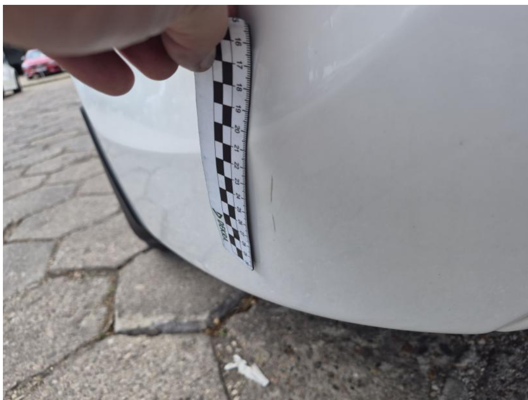
Fot. 48 Zderzak tylny - Rysa/odprysk 2
