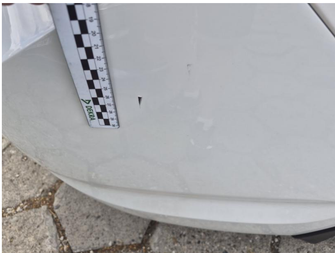
Fot. 47 Zderzak tylny - Rysa/odprysk 1
