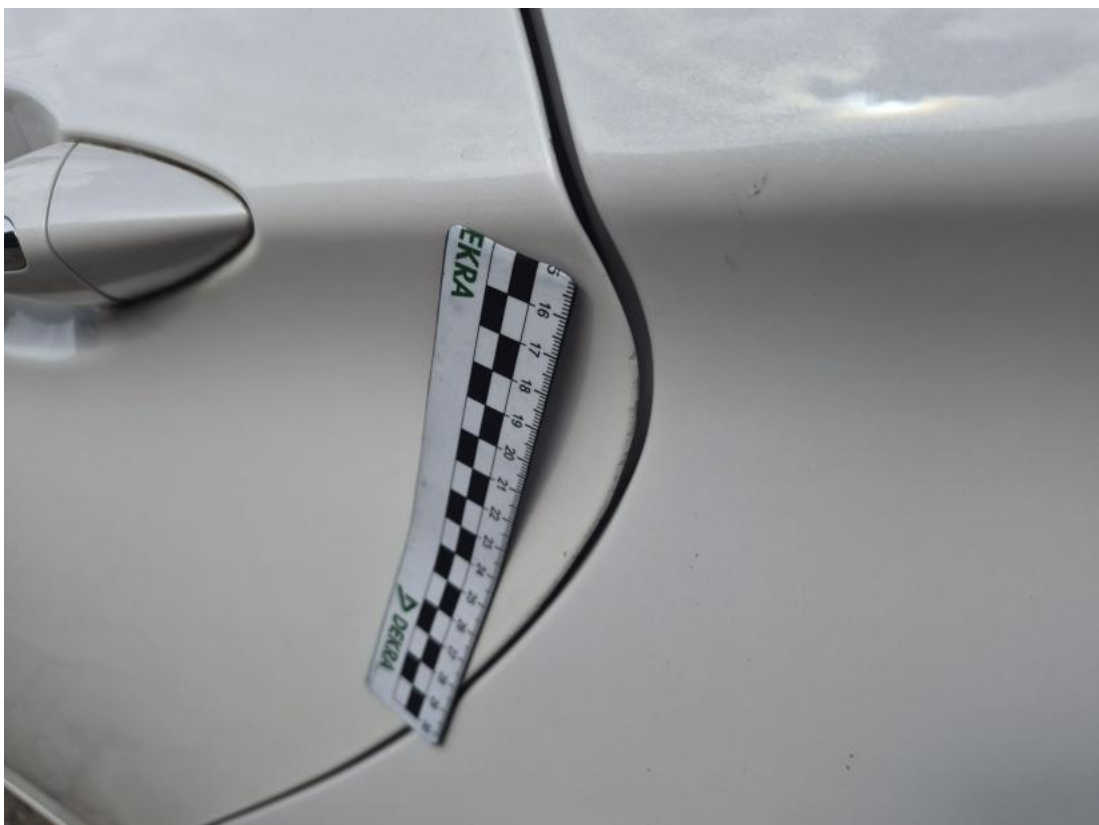
Fot. 54 Drzwi tylne L - Rysa/odprysk 1
