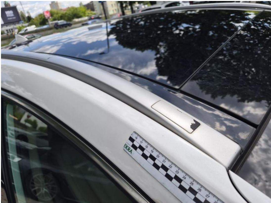
Fot. 51 Reling P - Rysa/odprysk 1
