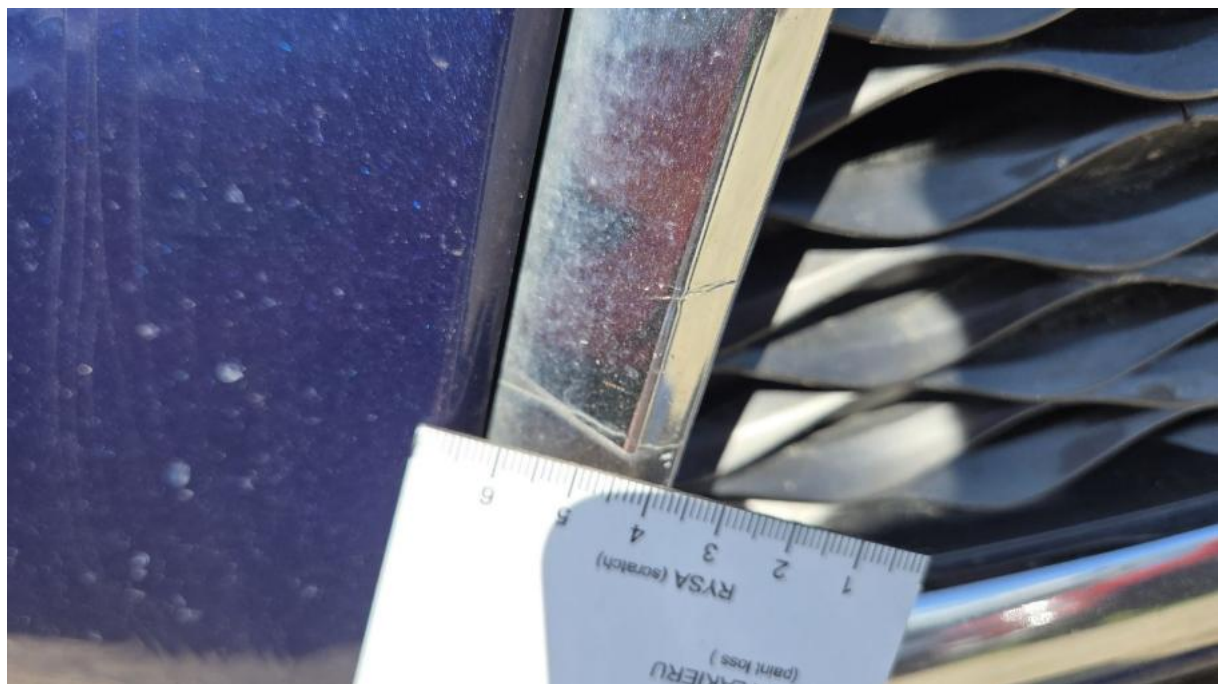
Fot. 38 Atrapa przednia - Pęknięcie/rozerwanie 1
