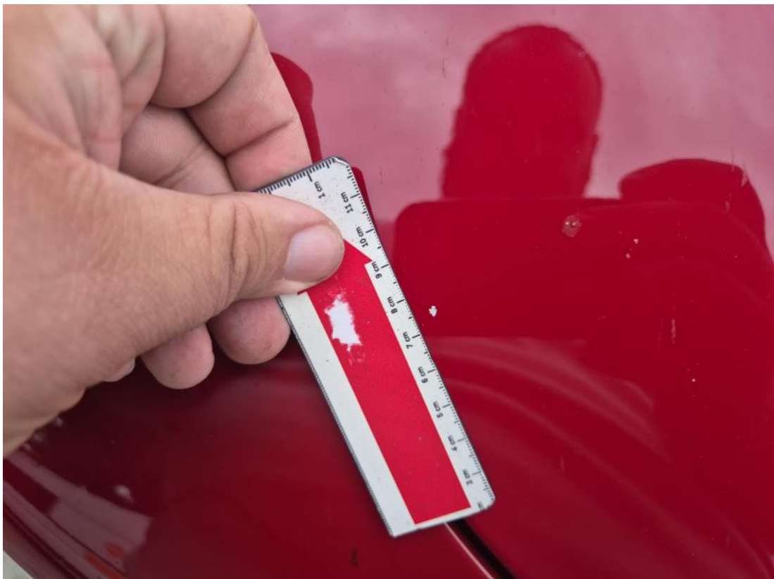
Fot. 38 Pokrywa komory silnika - Rysa/odprysk 1
