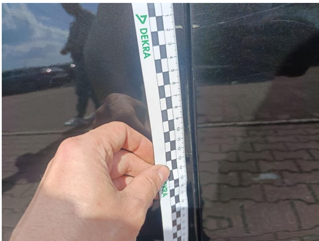
Fot. 49 Drzwi przed L - Rysa/odprysk 1
