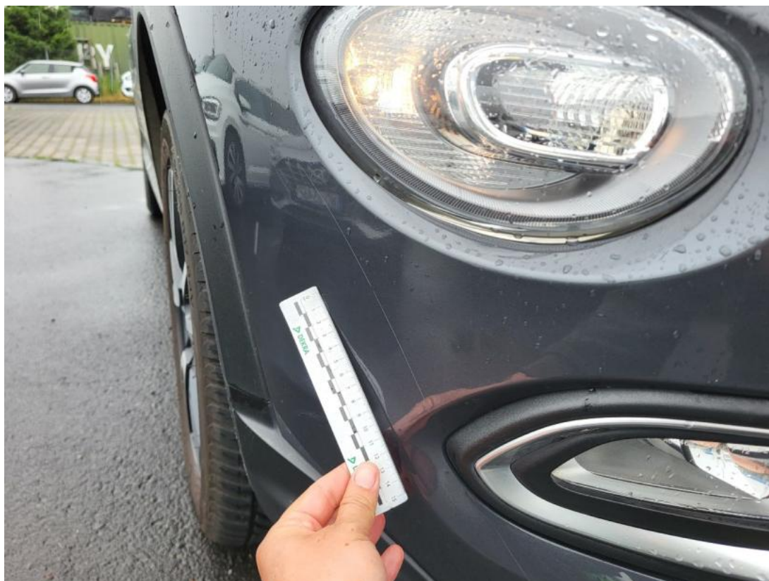
Fot. 41 Zderzak() - Rysa/odprysk 3
