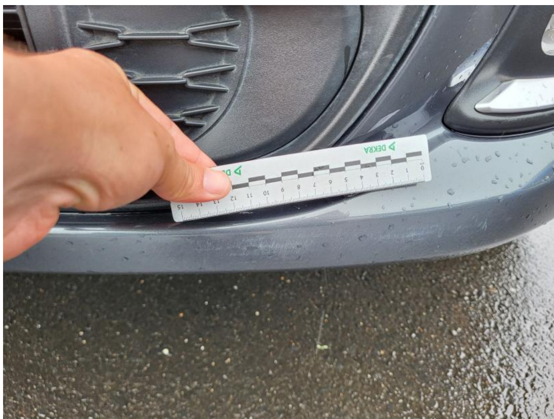
Fot. 39 Zderzak - Rysa/odprysk 1
