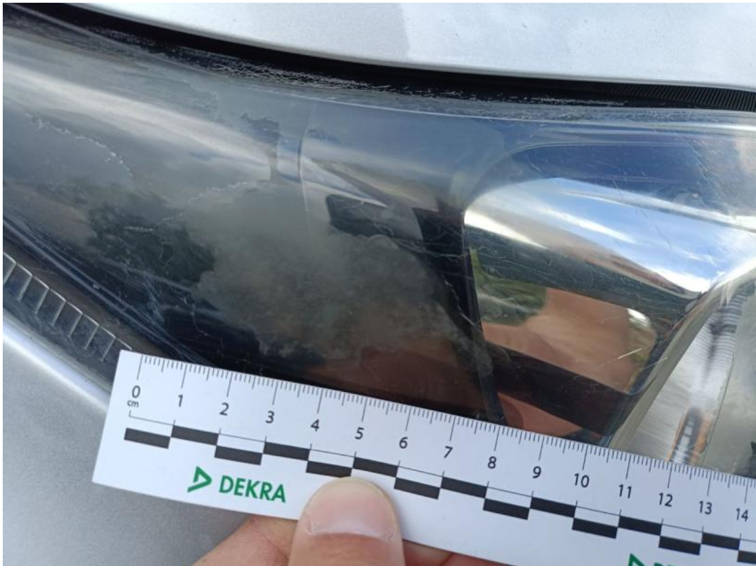
Fot. 49 Reflektor P - Rysa/odprysk 1
