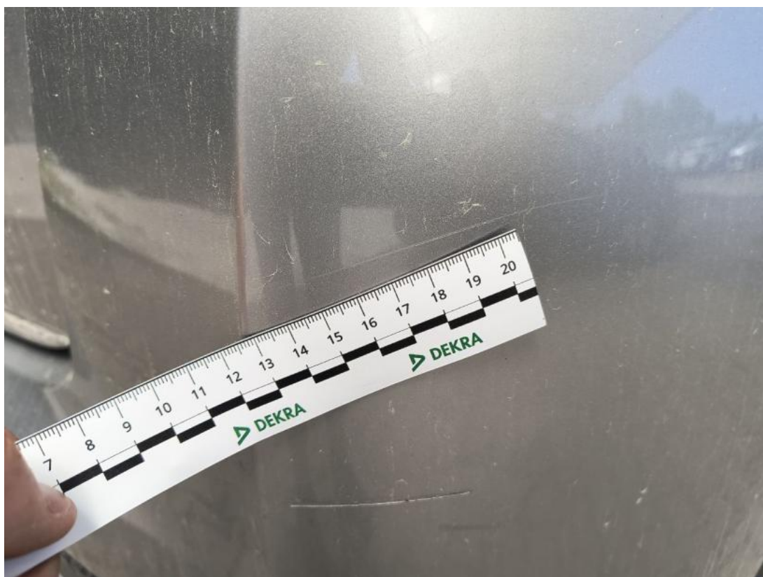
Fot. 46 Zderzak tylny - Rysa/odprysk 2
