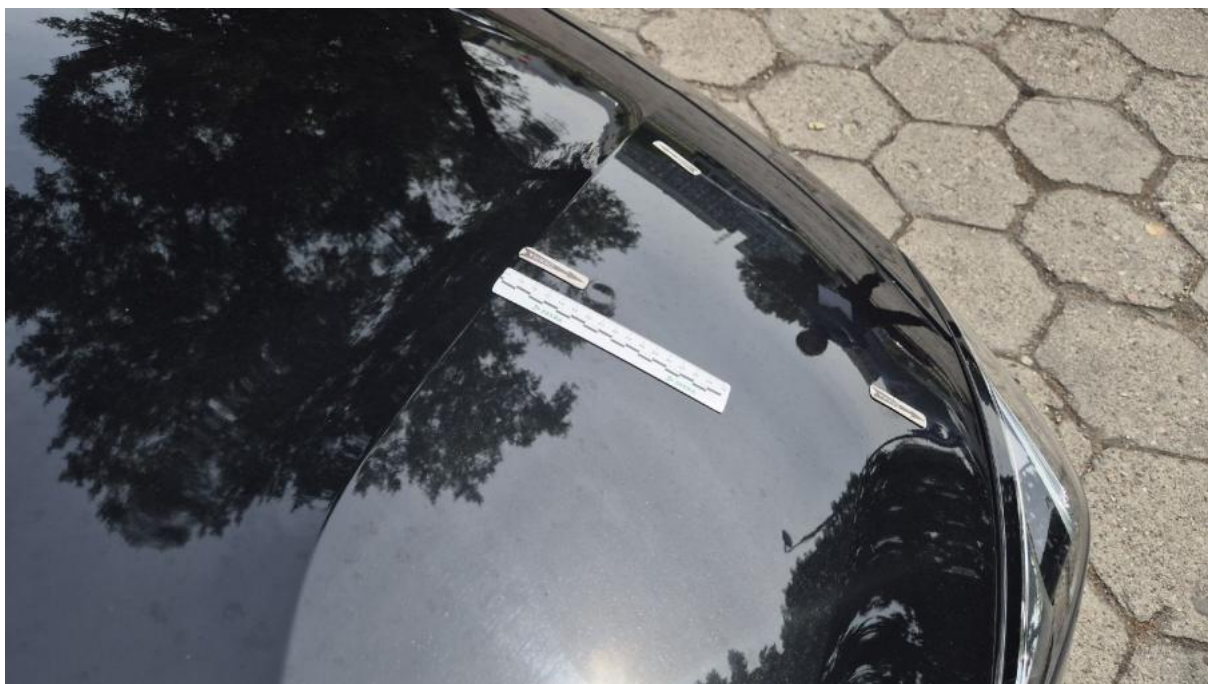
Fot. 38 Pokrywa komory silnika - Wgniecenie/odkształcenie 1
