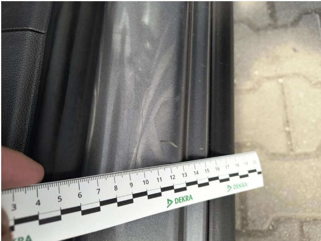
Fot. 45 Próg P - Rysa/odprysk 1
