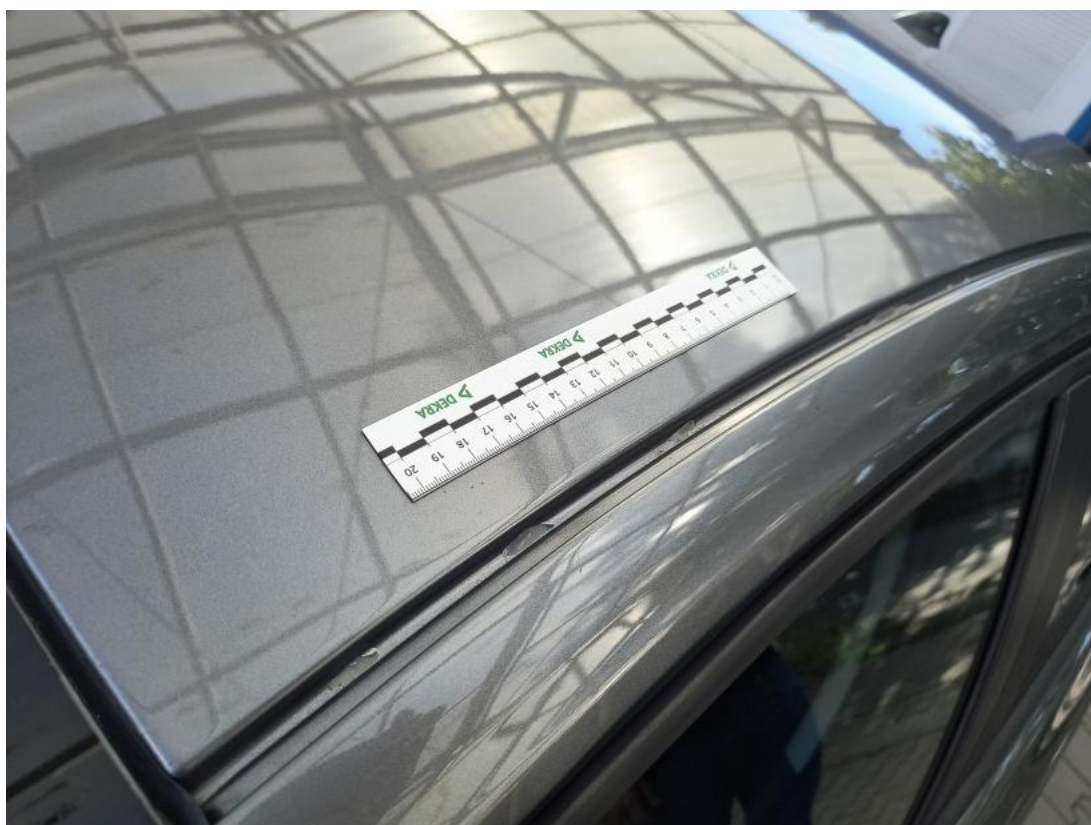
Fot. 56 Dach() - Rysa/odprysk 3
