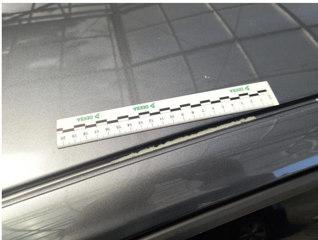
Fot. 55 Dach - Rysa/odprysk 2
