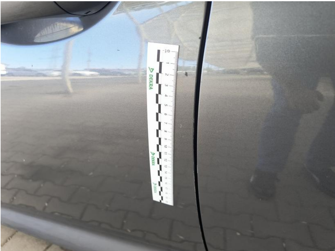
Fot. 59 Drzwi przed L - Rysa/odprysk 1
