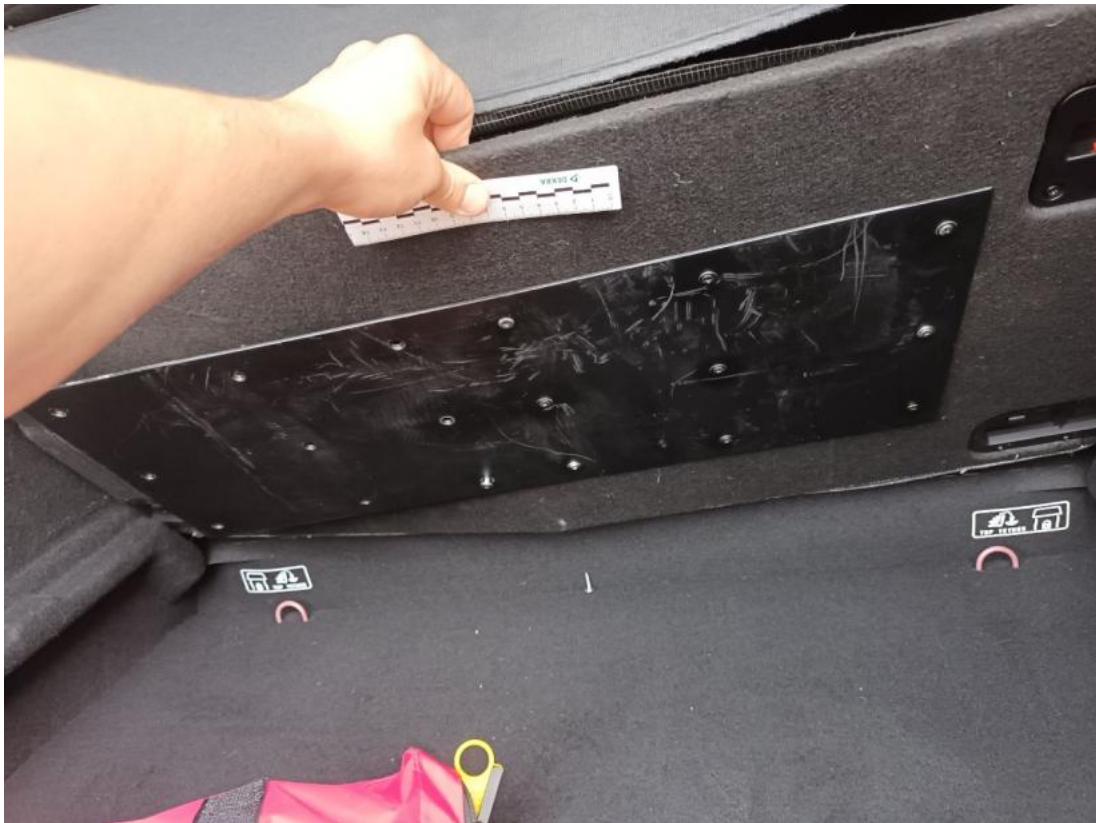
Fot. 71 Wykładzina podłogi bagażnika - Pęknięcie/rozerwanie 2
