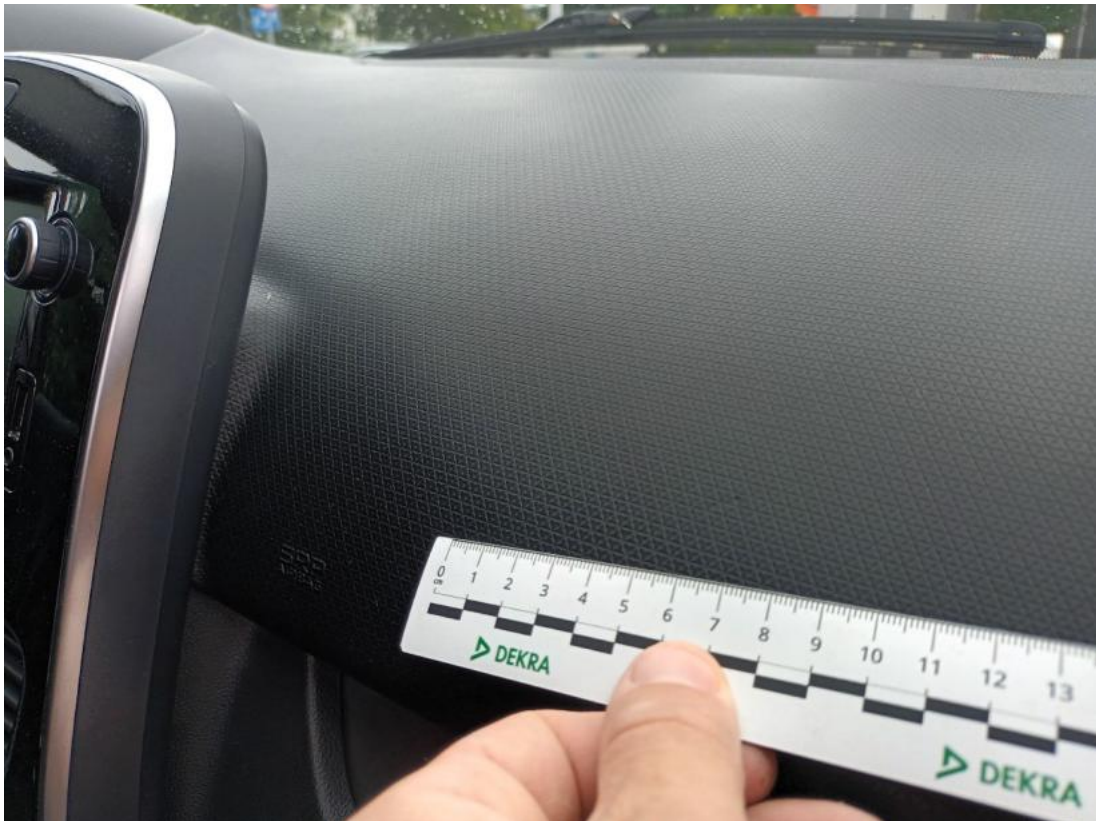
Fot. 61 Deska rozdzielcza - Wgniecenie/odkształcenie 1
