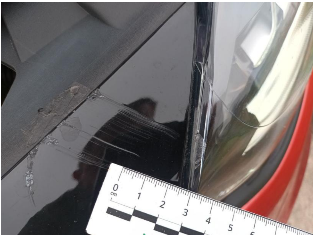
Fot. 60 Reflektor L - Rysa/odprysk 1
