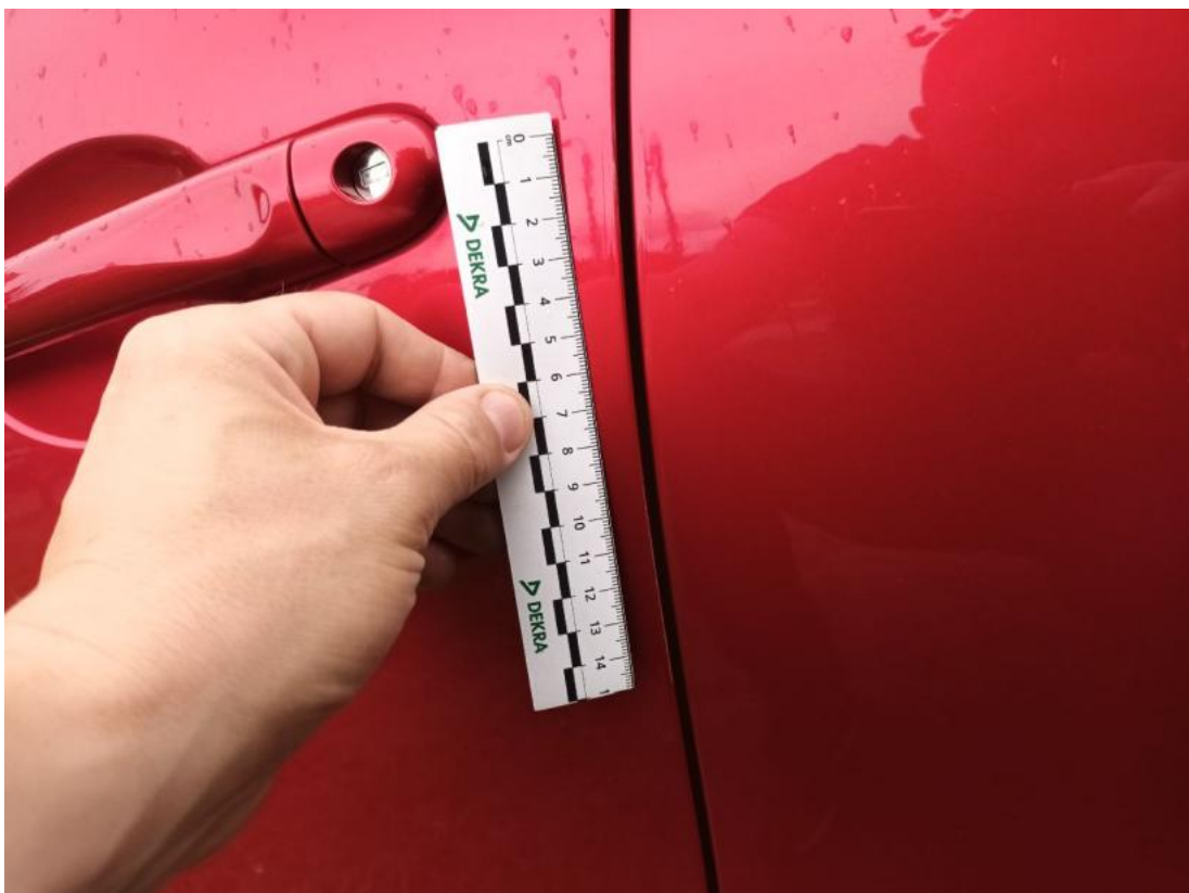
Fot. 54 Drzwi przed L - Rysa/odprysk 1
