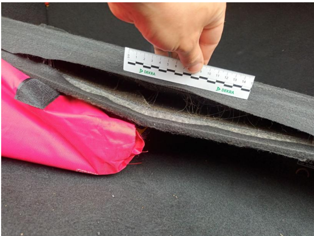
Fot. 72 Wykładzina podłogi bagażnika() - Pęknięcie/rozerwanie 3
