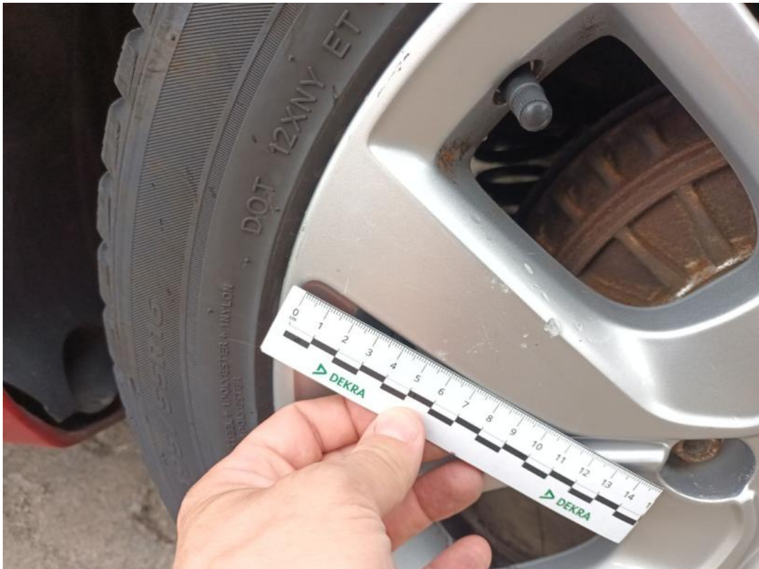
Fot. 53 Felga aluminiowa tylna L - Wgniecenie/odkształcenie 1
