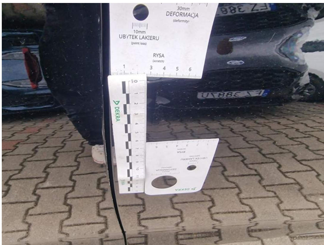
Fot. 71 Drzwi tylne L - Wgniecenie/odkształcenie 1
