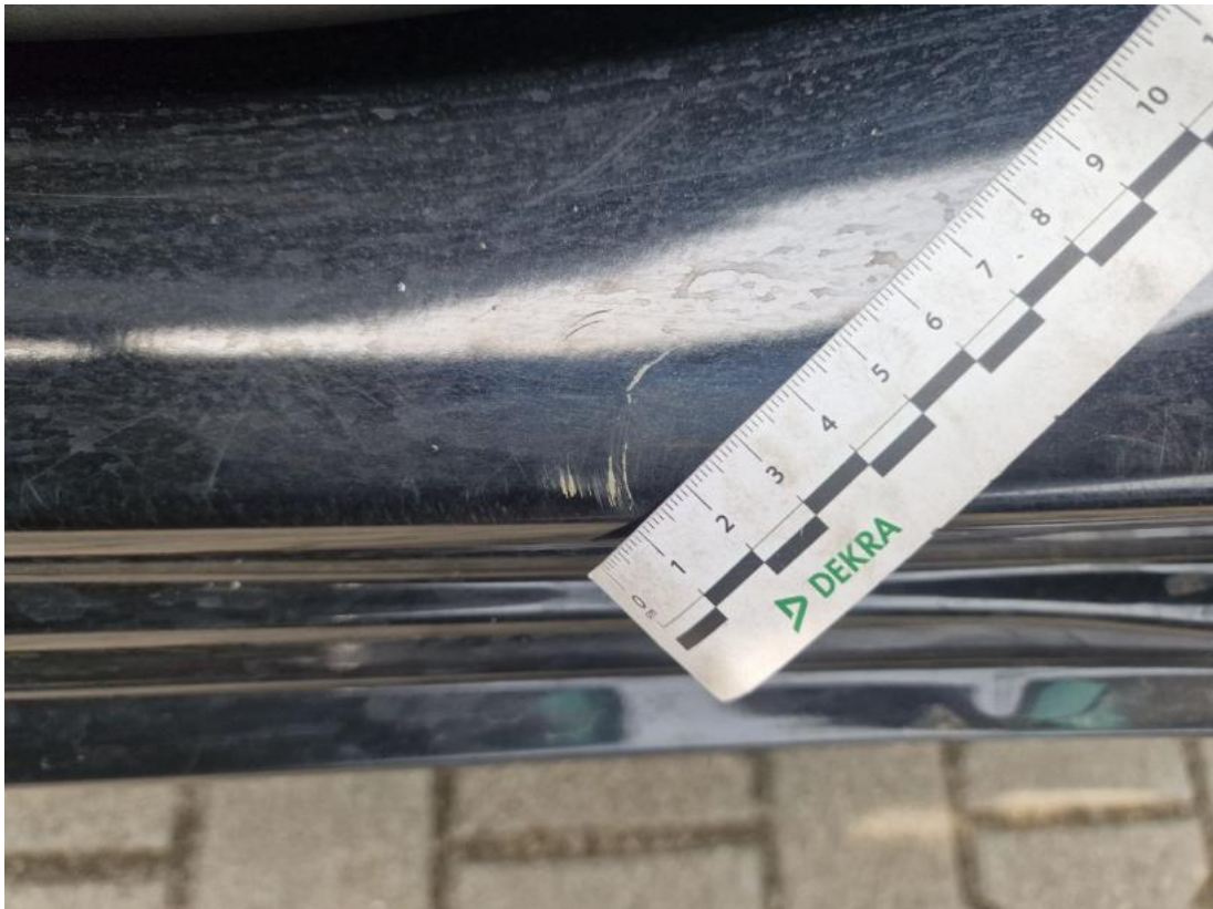
Fot. 73 Próg L - Rysa/odprysk 1
