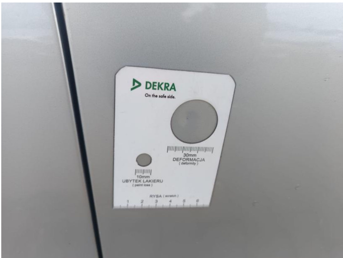
Fot. 48 Drzwi przednie P - Wgniecenie/odkształcenie 2
