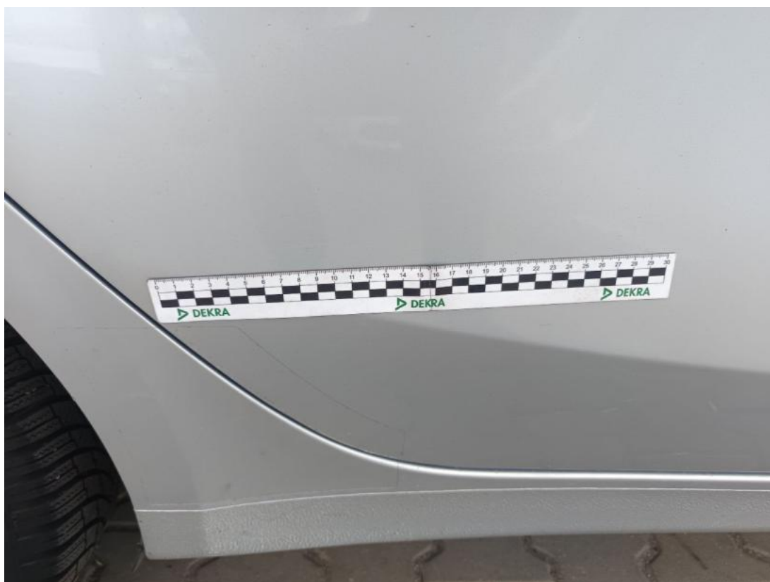
Fot. 51 Drzwi tylne P - Rysa/odprysk 2
