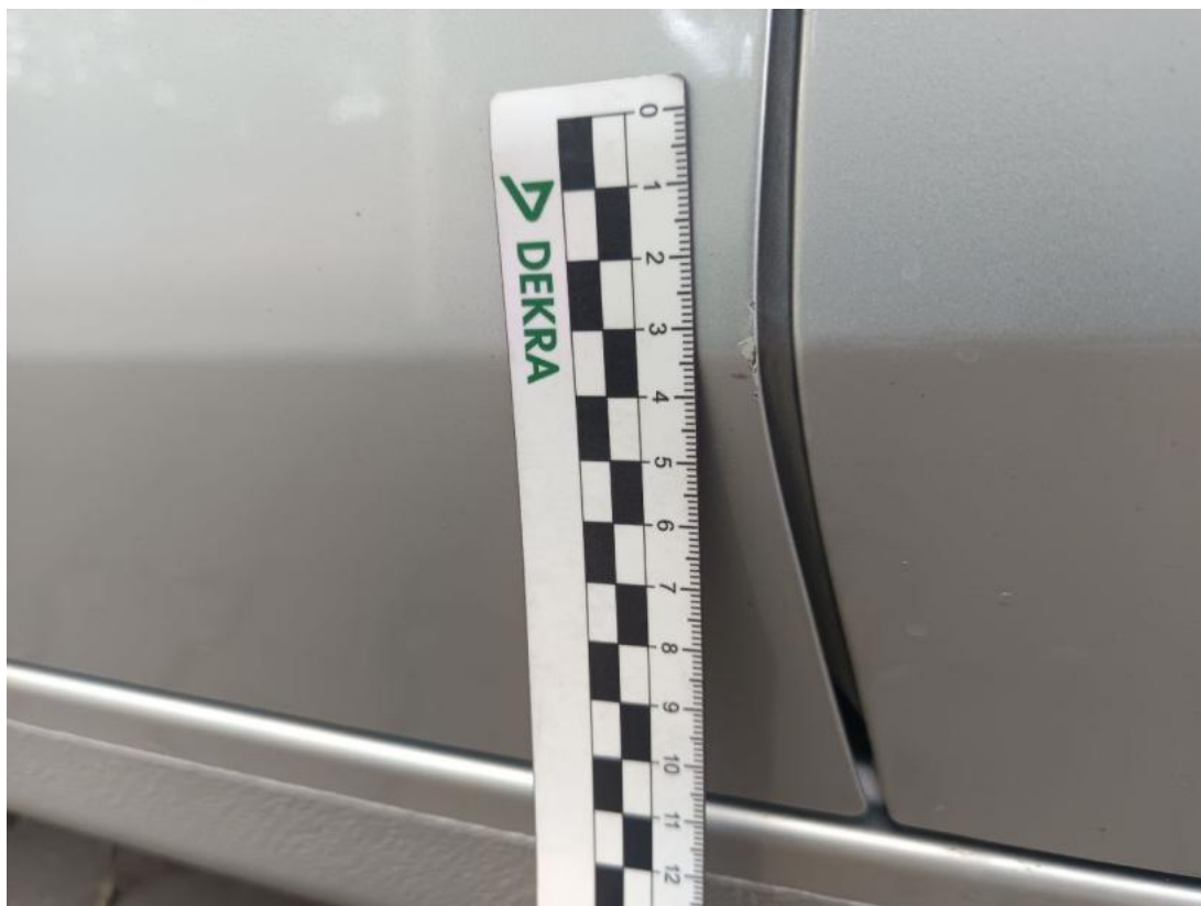
Fot. 61 Drzwi przed L - Rysa/odprysk 1
