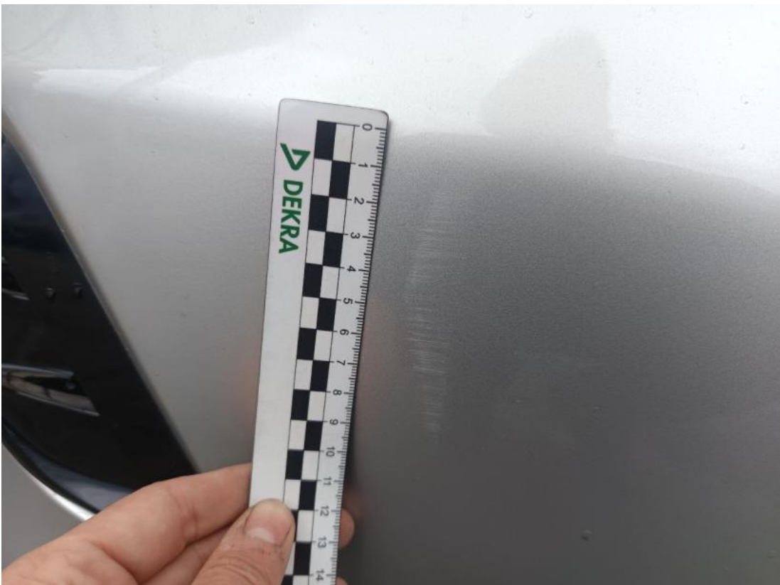
Fot. 56 Zderzak tylny - Rysa/odprysk 1
