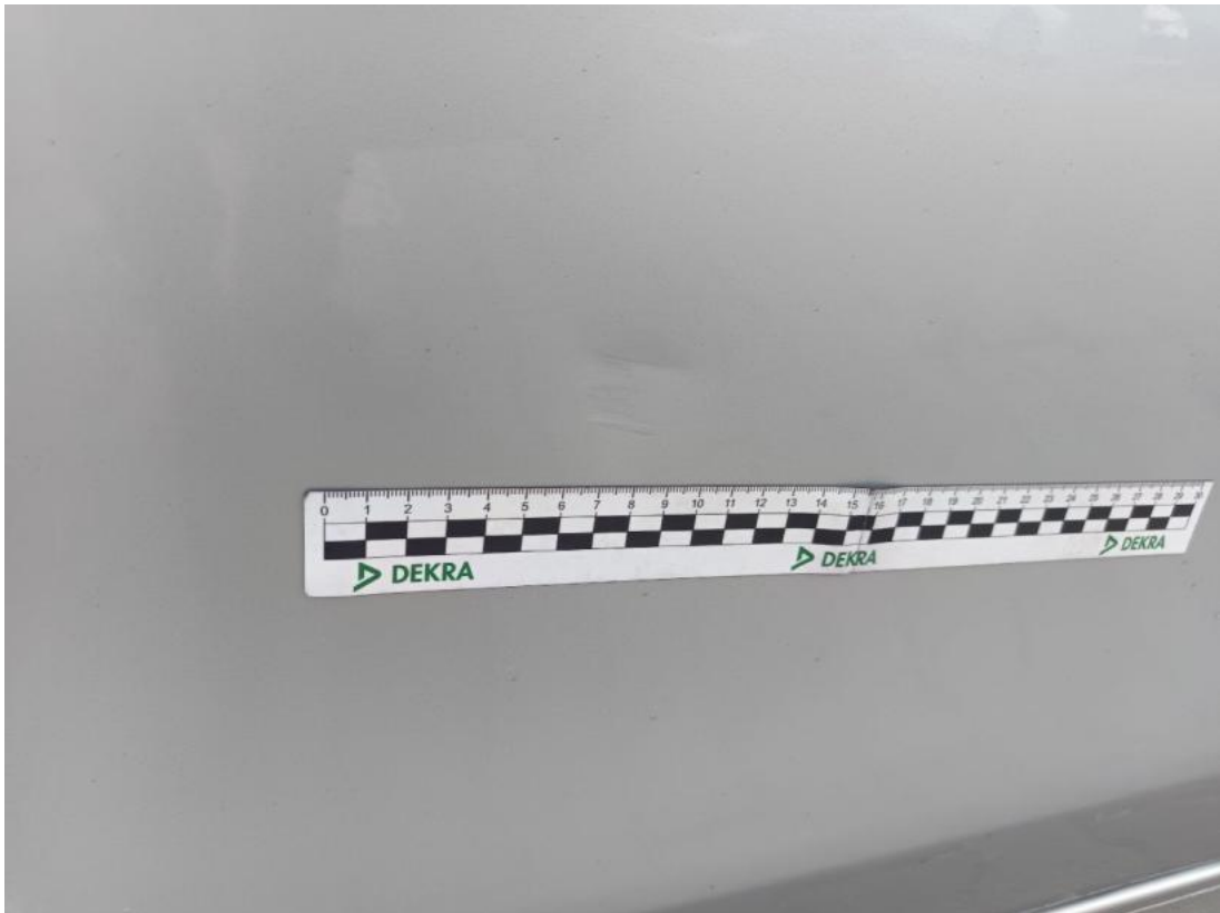
Fot. 47 Drzwi przednie P - Wgniecenie/odkształcenie 1
