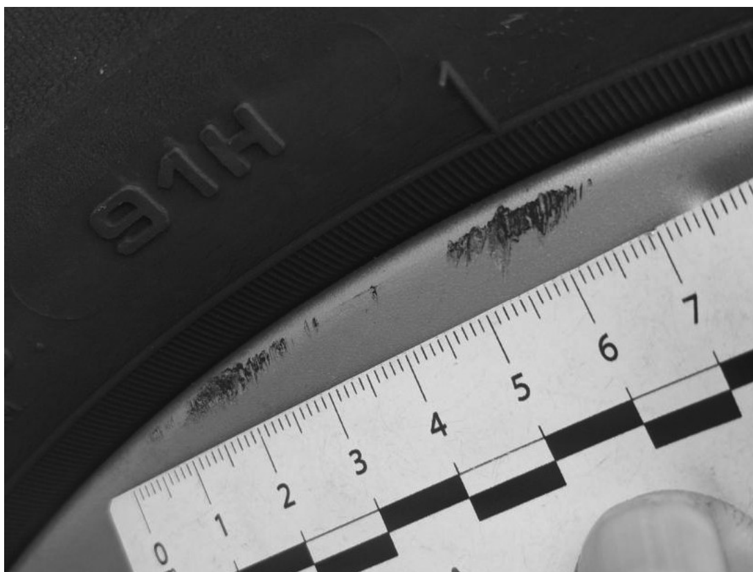
Fot. 49 Felga aluminiowa przednia P - Rysa/odprysk 2
