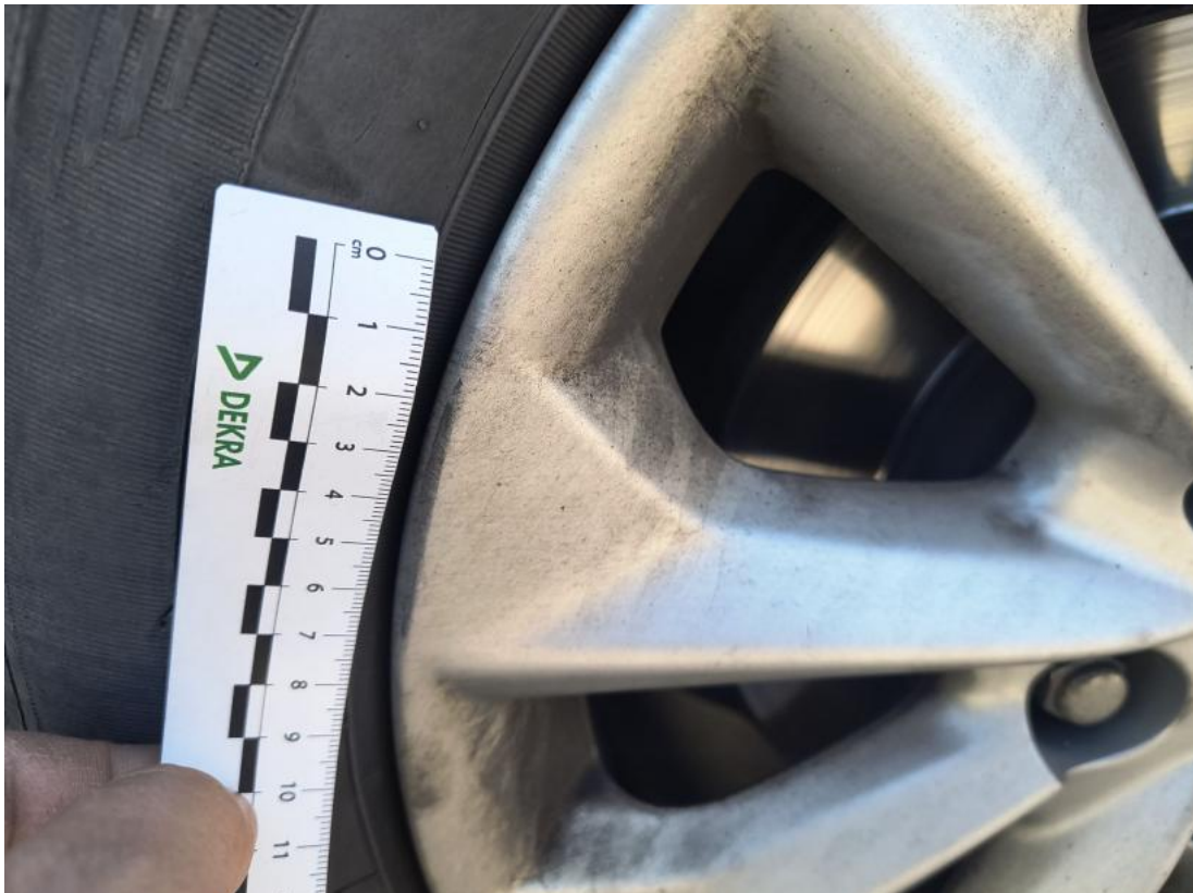
Fot. 45 Felga aluminiowa przednia P - Rysa/odprysk 1
