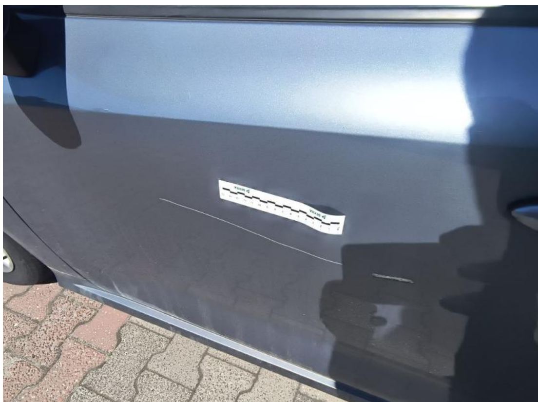
Fot. 58 Drzwi przed L - Rysa/odprysk 1
