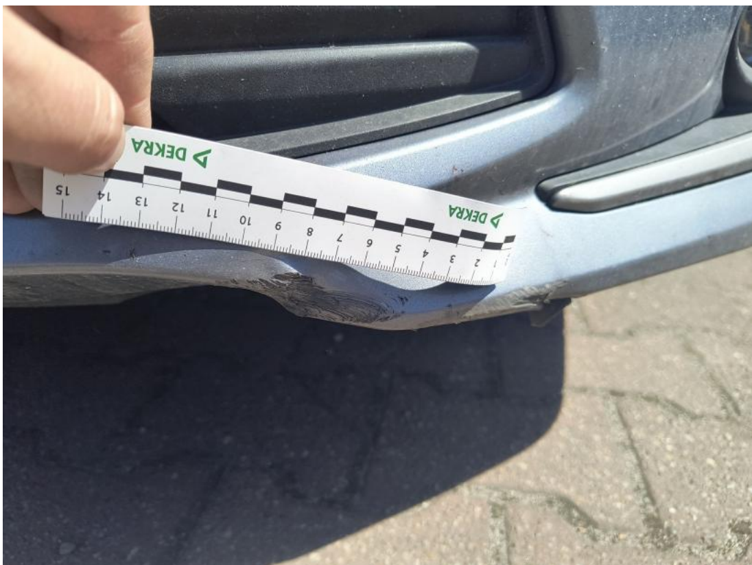
Fot. 42 Zderzak - Wgniecenie/odkształcenie 1
