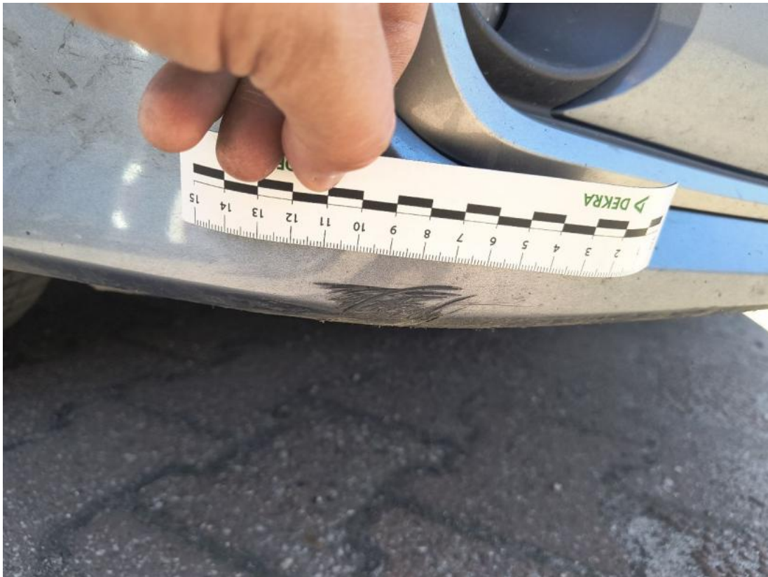
Fot. 41 Zderzak - Rysa/odprysk 1
