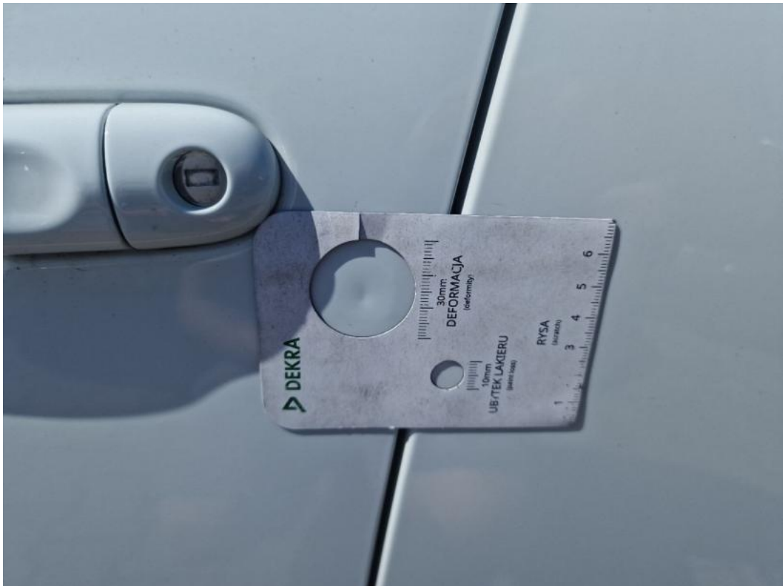
Fot. 51 Drzwi przed L - Wgniecenie/odkształcenie 1
