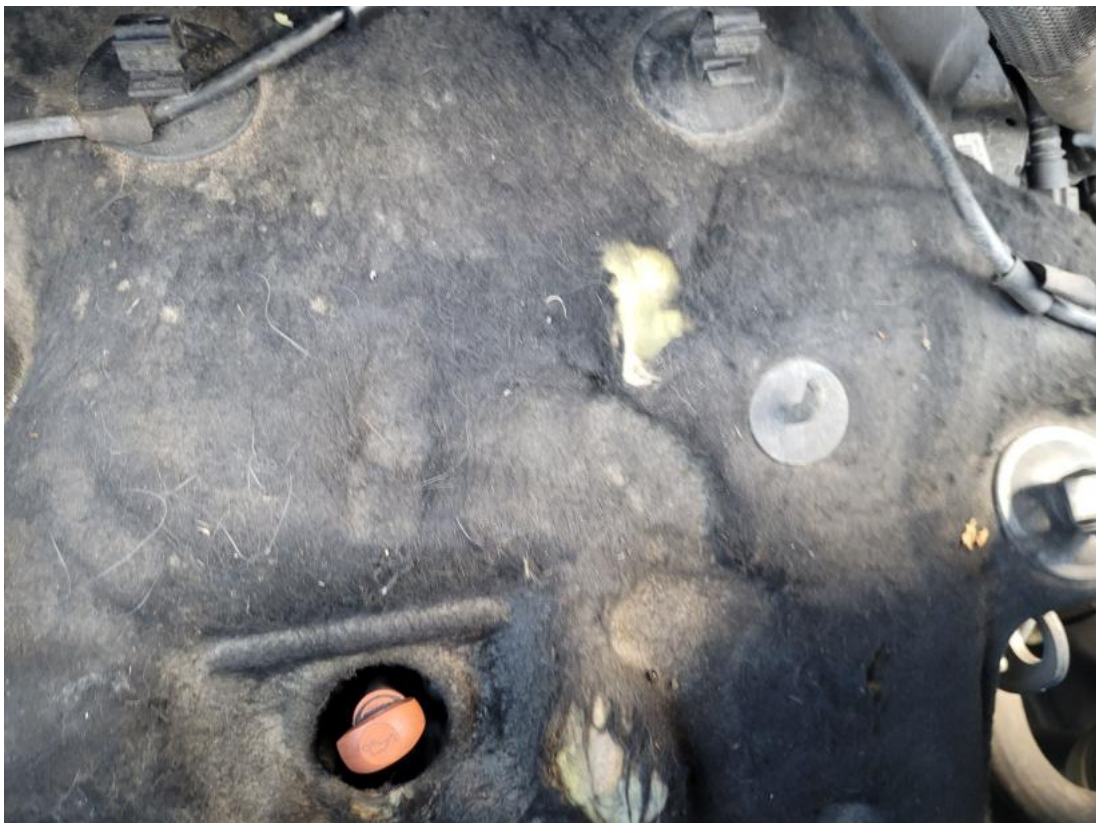
Fot. 40 Wykładzina pokrywy komory silnika - Pęknięcie/rozerwanie 1
