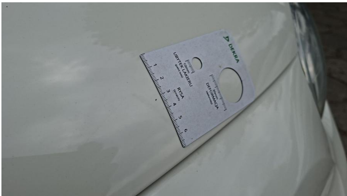
Fot. 38 Pokrywa komory silnika - Rysa/odprysk 1
