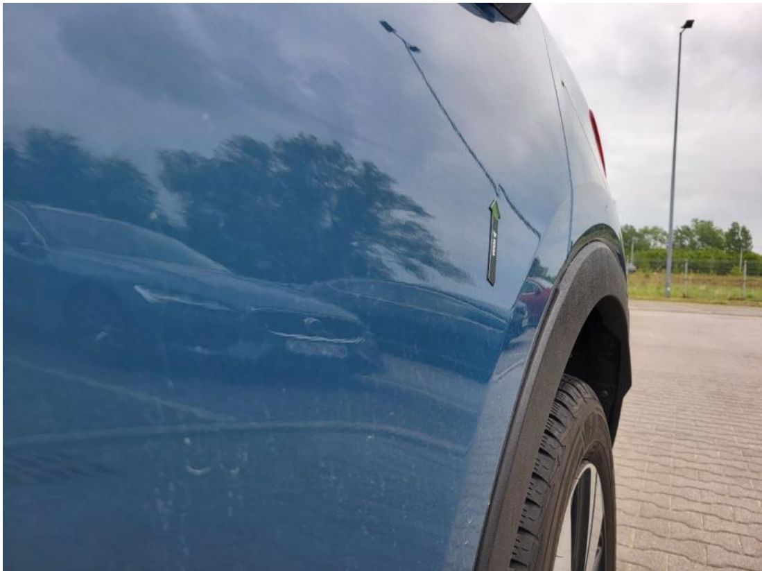
Fot. 49 Drzwi tylne L - Wgniecenie/odkształcenie 1
