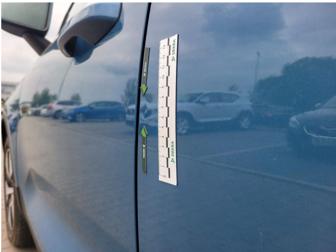
Fot. 50 Drzwi tylne L - Wgniecenie/odkształcenie 2
