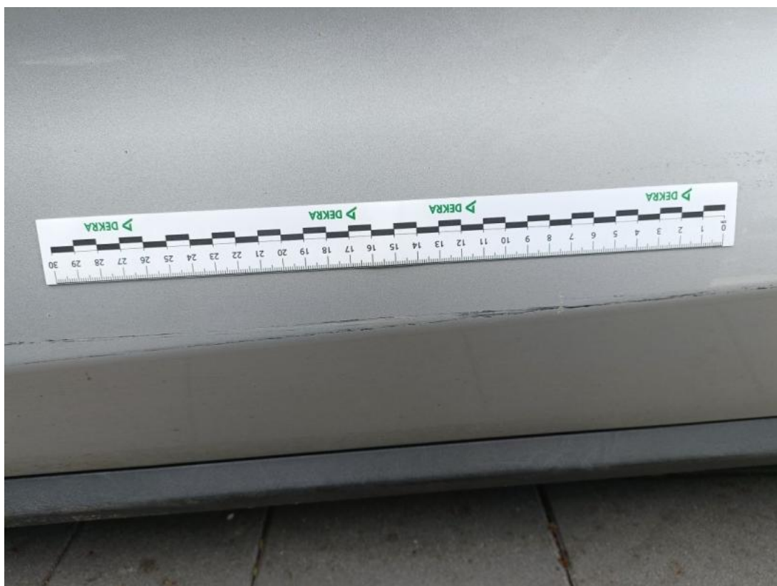
Fot. 53 Drzwi przed L - Rysa/odprysk 1
