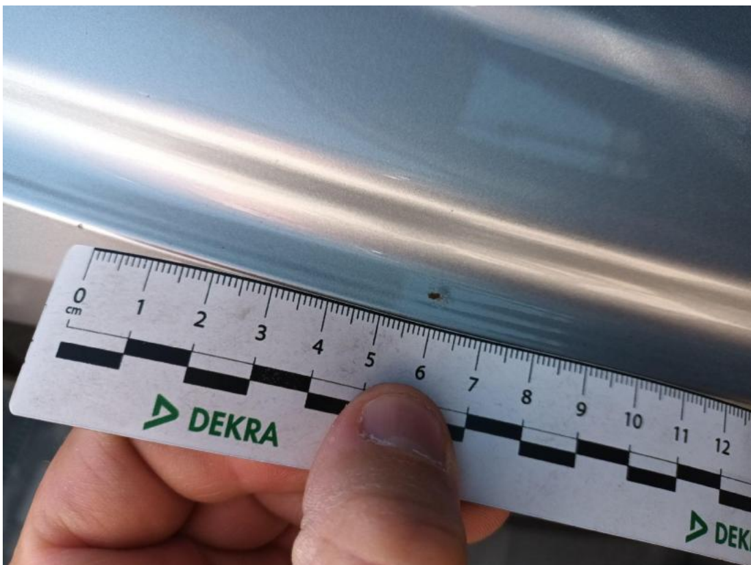
Fot. 54 Błotnik tylny P / Ściana boczna P - Ślady korozji 1
