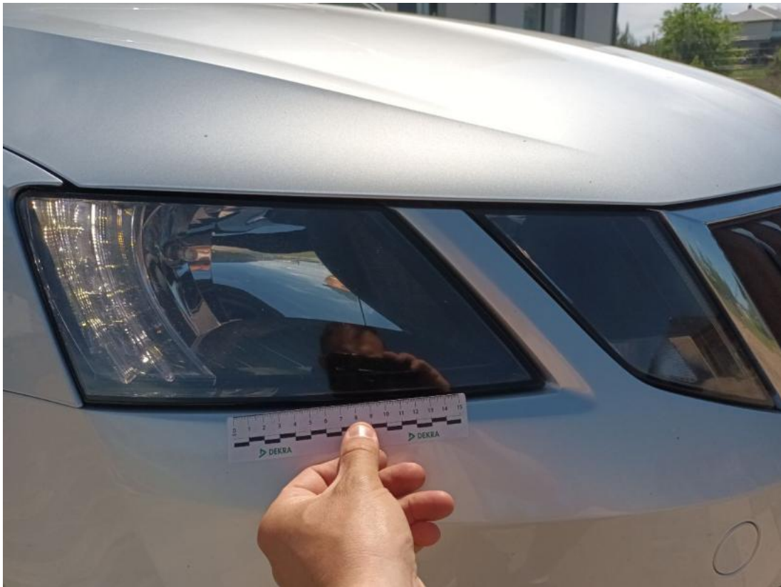
Fot. 47 Reflektor P - Rysa/odprysk 1
