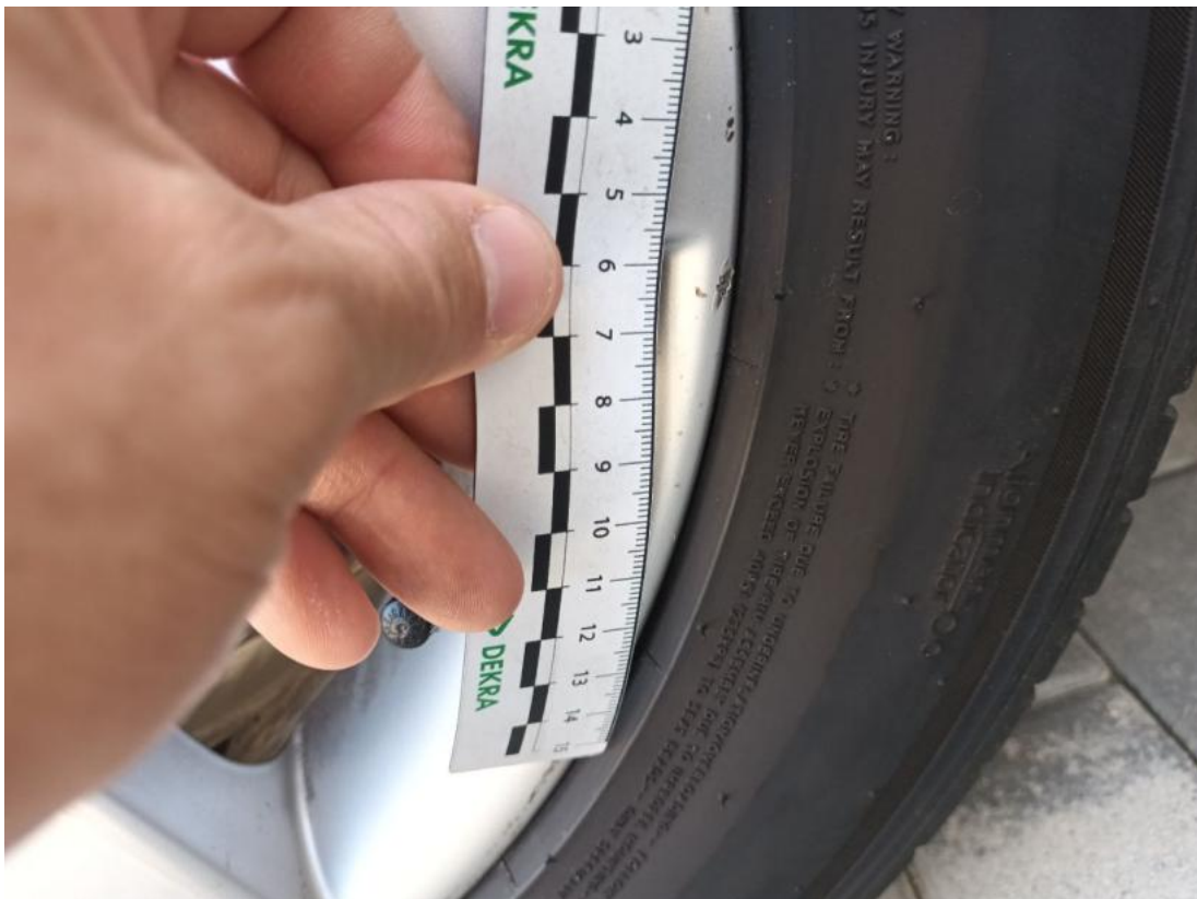
Fot. 61 Felga aluminiowa tylna L - Rysa/odprysk 1
