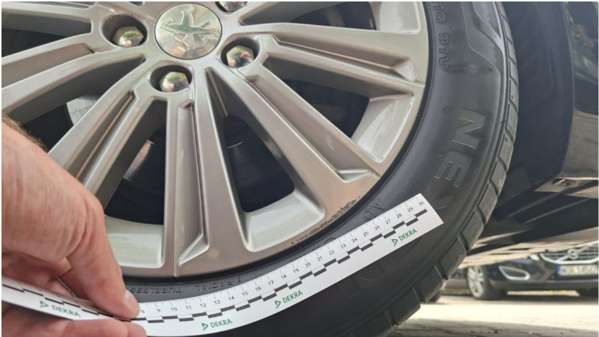
Fot. 49 Felga aluminiowa przednia P() - Rysa/odprysk 3
