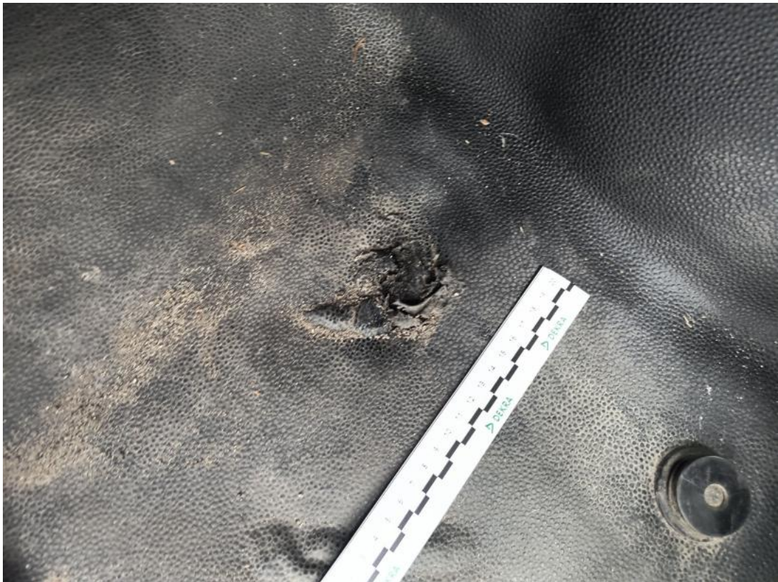
Fot. 103 Wykładzina podłogi - Pęknięcie/rozerwanie 1
