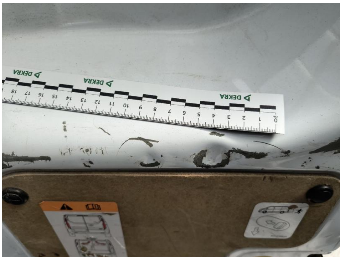
Fot. 109 Drzwi tyłu prawe - Wgniecenie/odkształcenie 1
