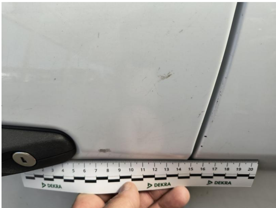
Fot. 83 Drzwi przed L - Rysa/odprysk 2
