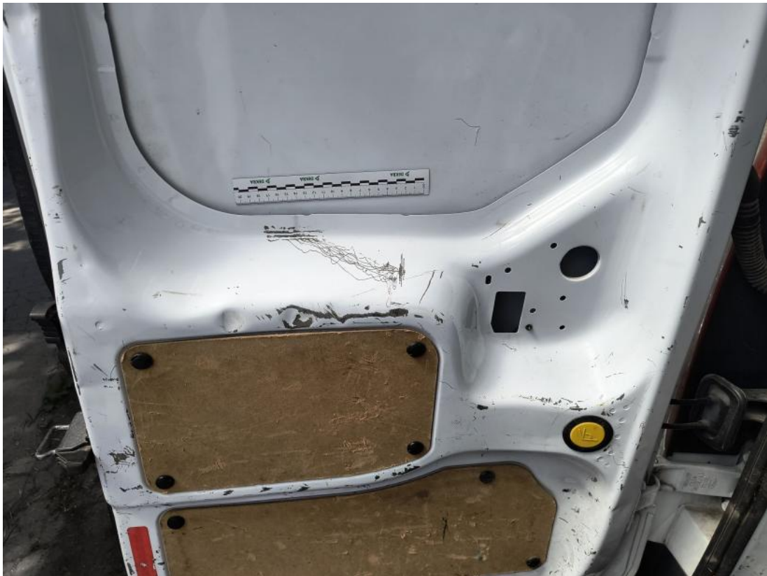
Fot. 105 Drzwi tyłu lewe - Rysa/odprysk 1
