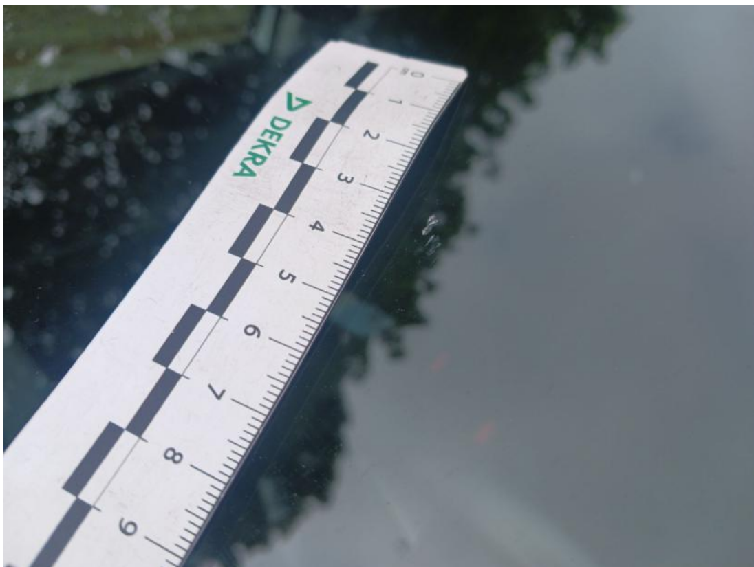
Fot. 36 Szyba czołowa - Rysa/odprysk 1
