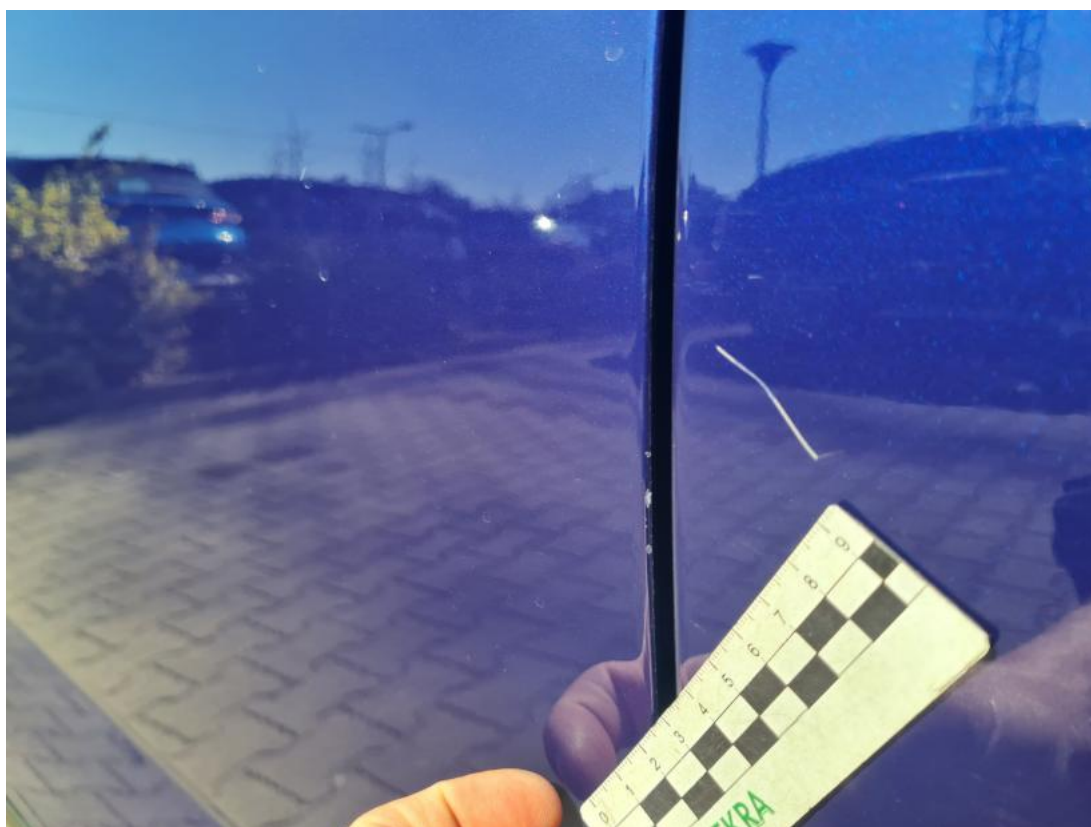
Fot. 50 Drzwi przed L - Rysa/odprysk 1
