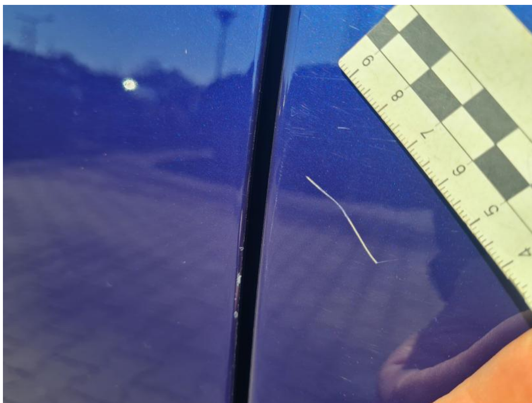
Fot. 52 Drzwi tylne L() - Rysa/odprysk 3
