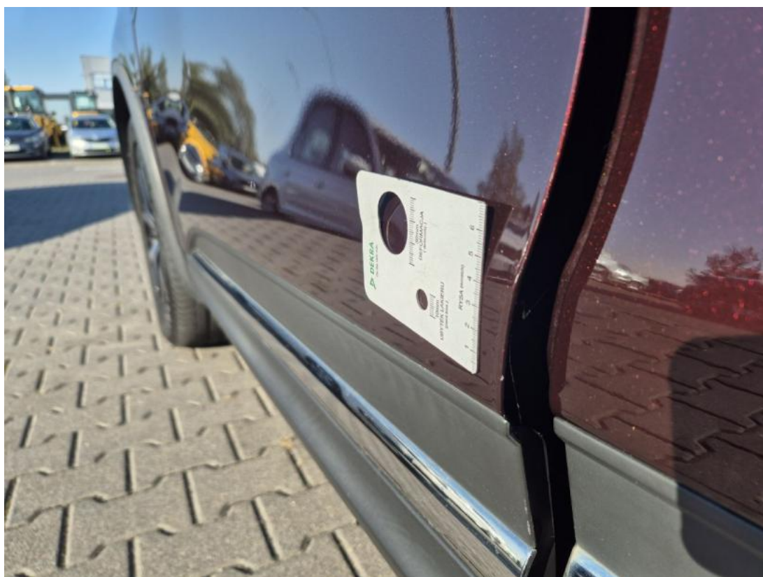
Fot. 54 Drzwi przed L - Rysa/odprysk 1
