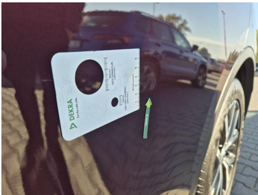
Fot. 57 Drzwi tylne L - Wgniecenie/odkształcenie 1
