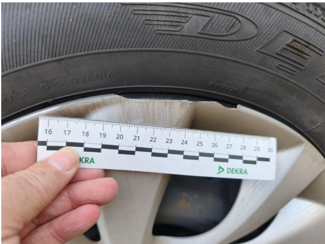
Fot. 38 Kołpak przedni P - Pęknięcie/rozerwanie 1
