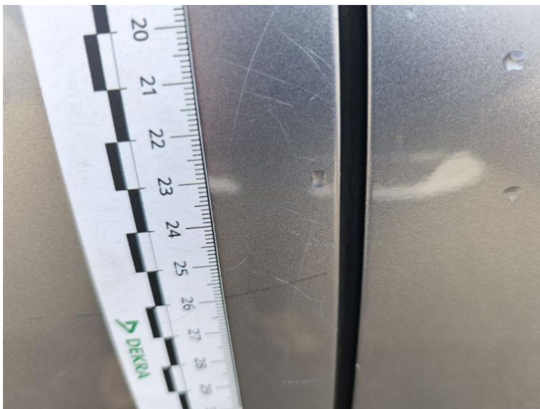
Fot. 39 Drzwi tylne P - Rysa/odprysk 1
