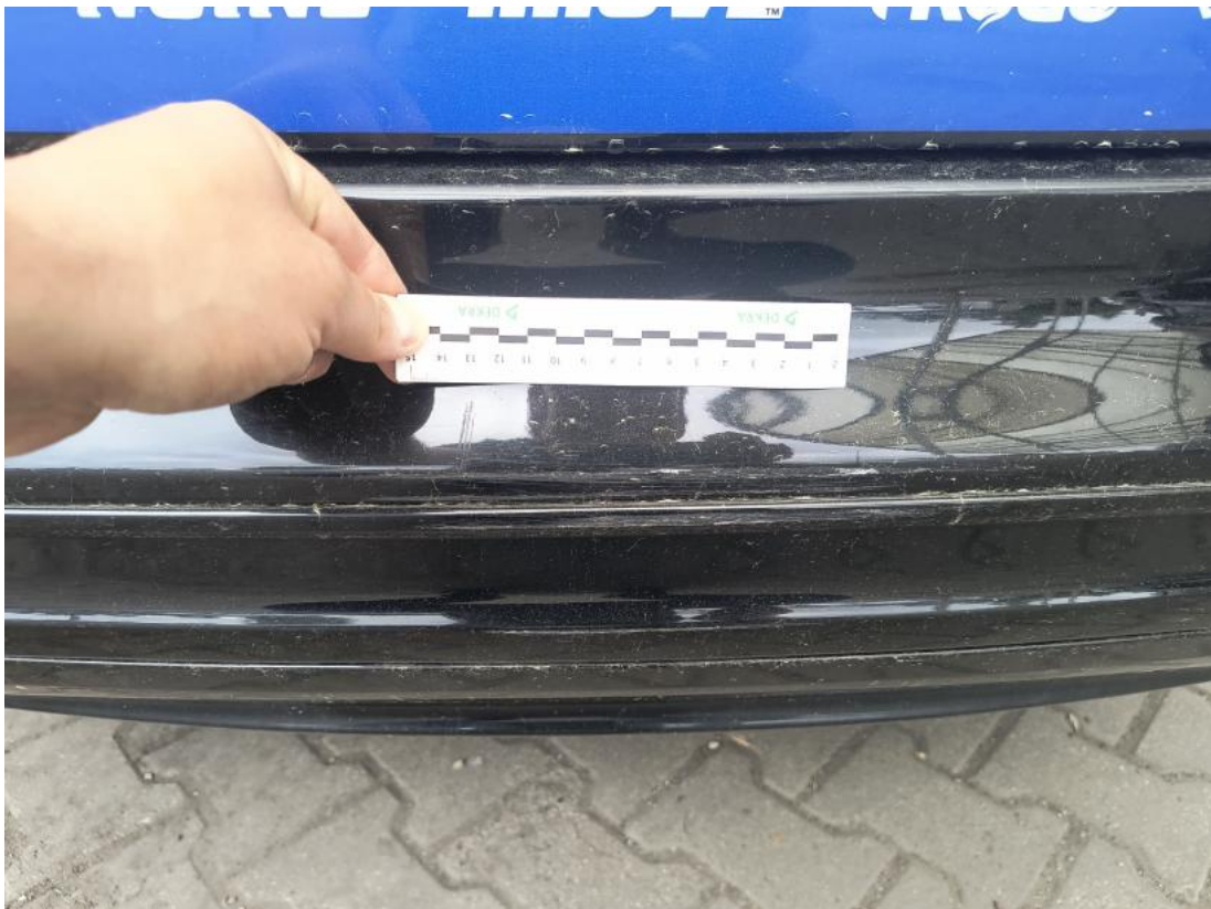
Fot. 45 Zderzak tylny - Rysa/odprysk 1
