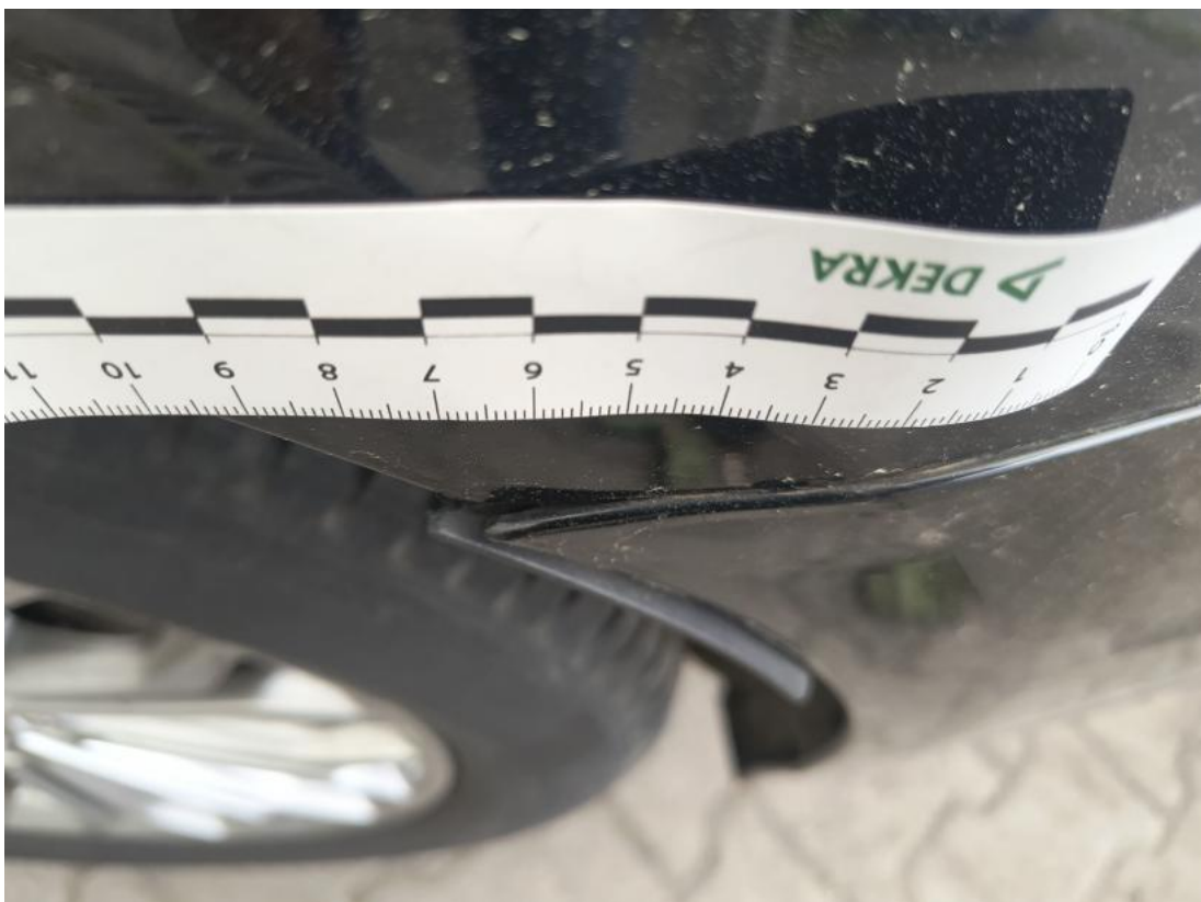
Fot. 46 Zderzak tylny - Wgniecenie/odkształcenie 1
