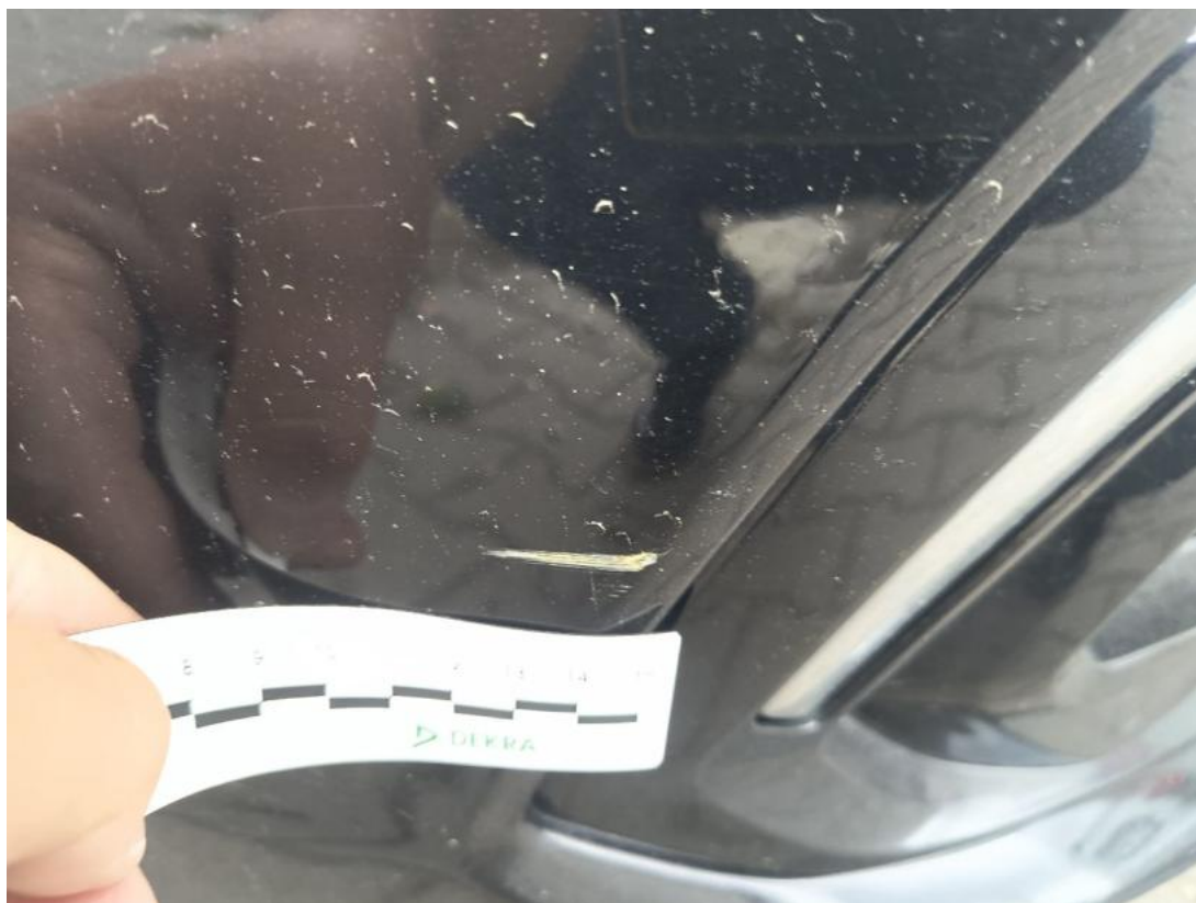
Fot. 43 Zderzak - Rysa/odprysk 2
