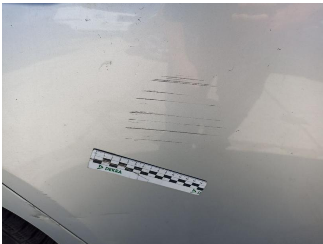
Fot. 43 Drzwi tylne P - Rysa/odprysk 1
