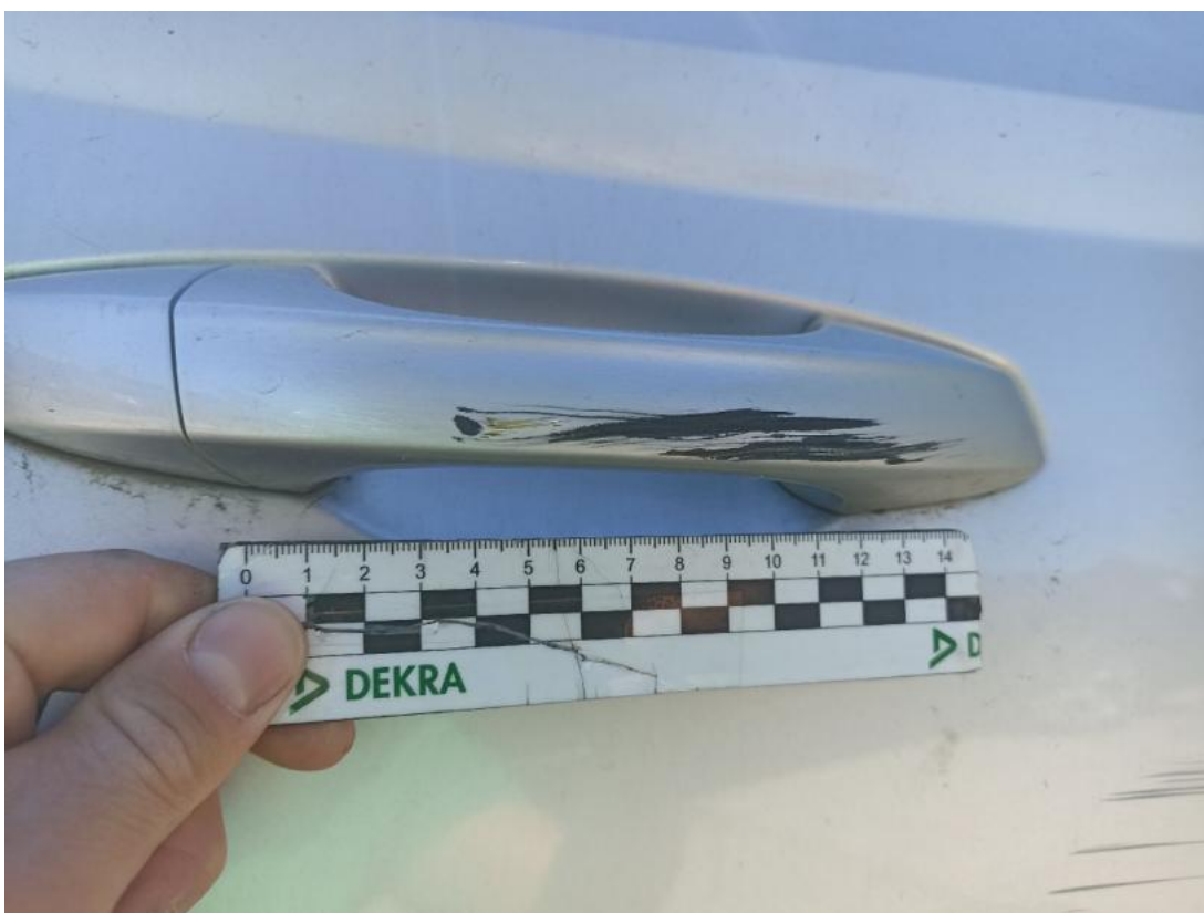
Fot. 46 Klamka drzwi tyl P - Rysa/odprysk 1
