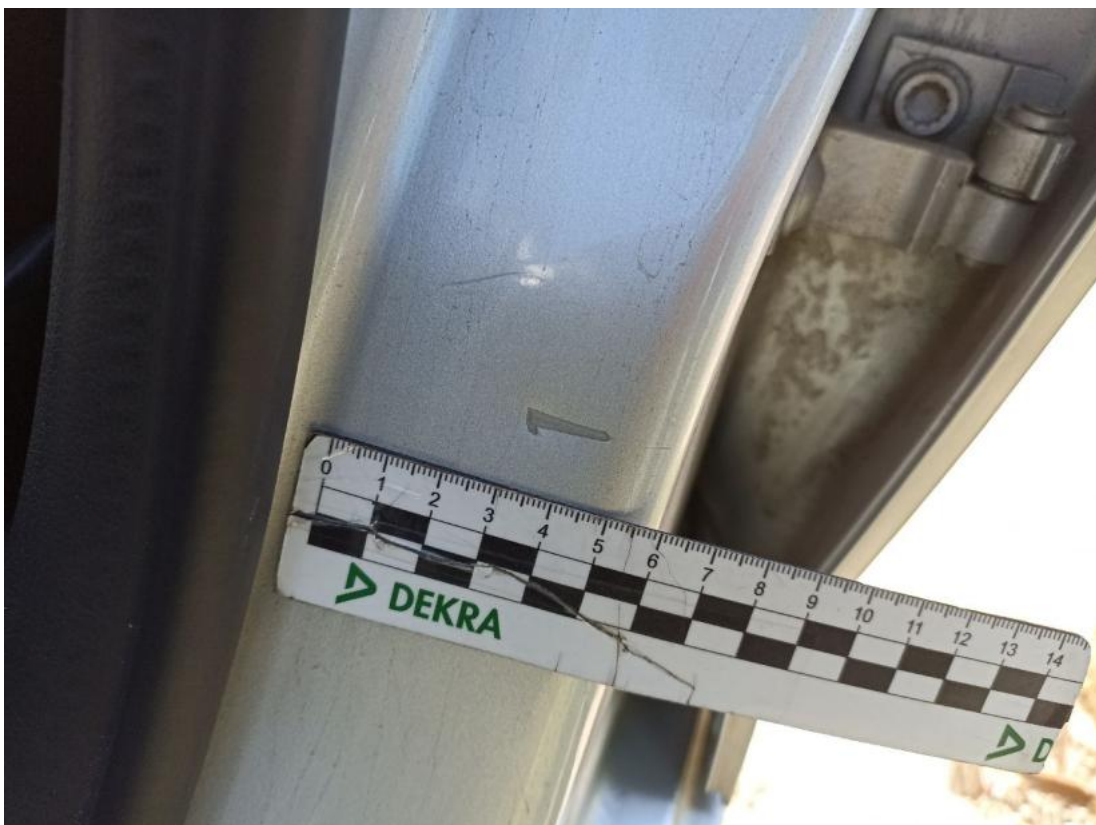
Fot. 54 Słupek środkowy L - Rysa/odprysk 1
