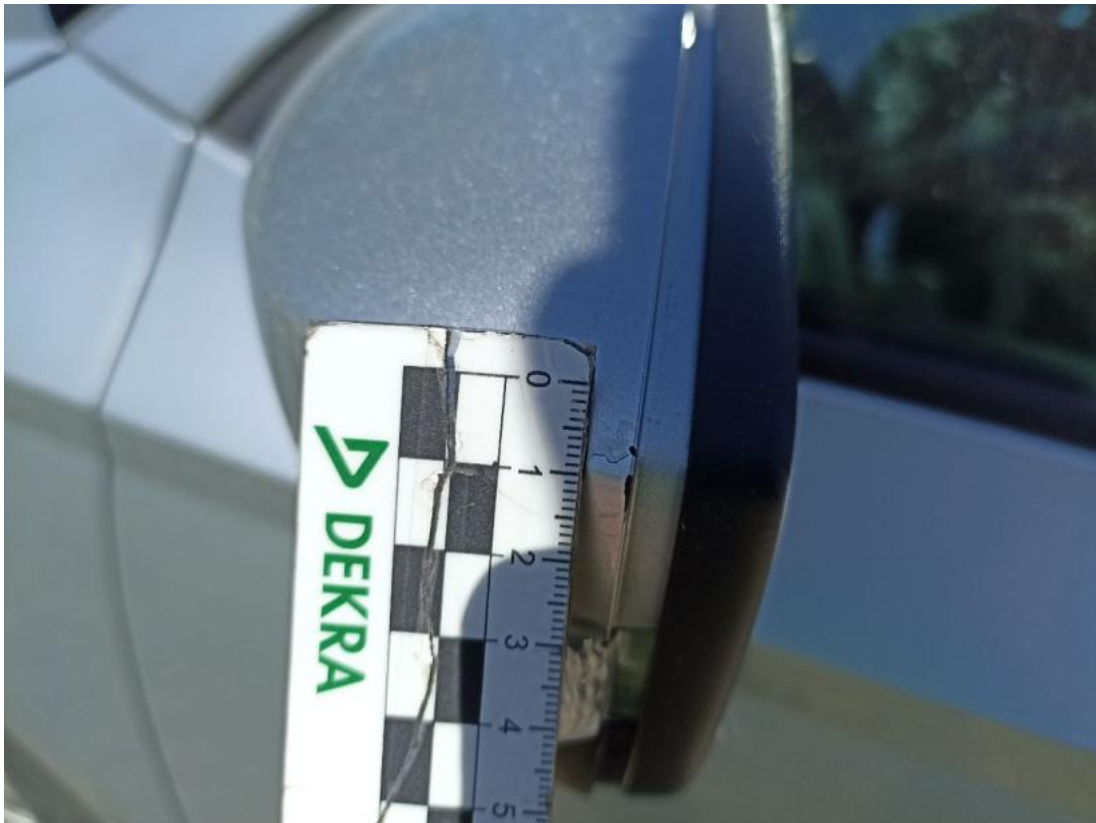
Fot. 53 Obudowa lusterka zew L - Rysa/odprysk 1
