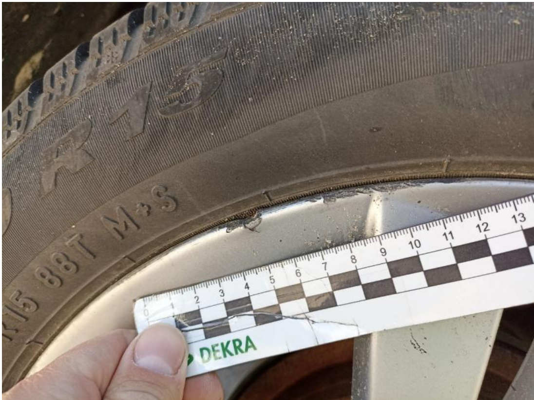
Fot. 49 Felga aluminiowa tylna P - Wgniecenie/odkształcenie 1
