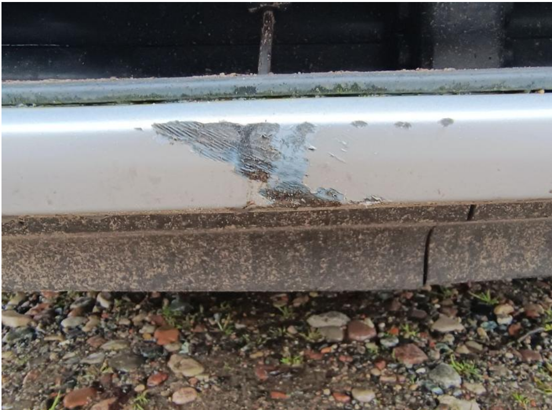
Fot. 31 Zderzak przedni cz dolna - Rysa/odprysk 1
