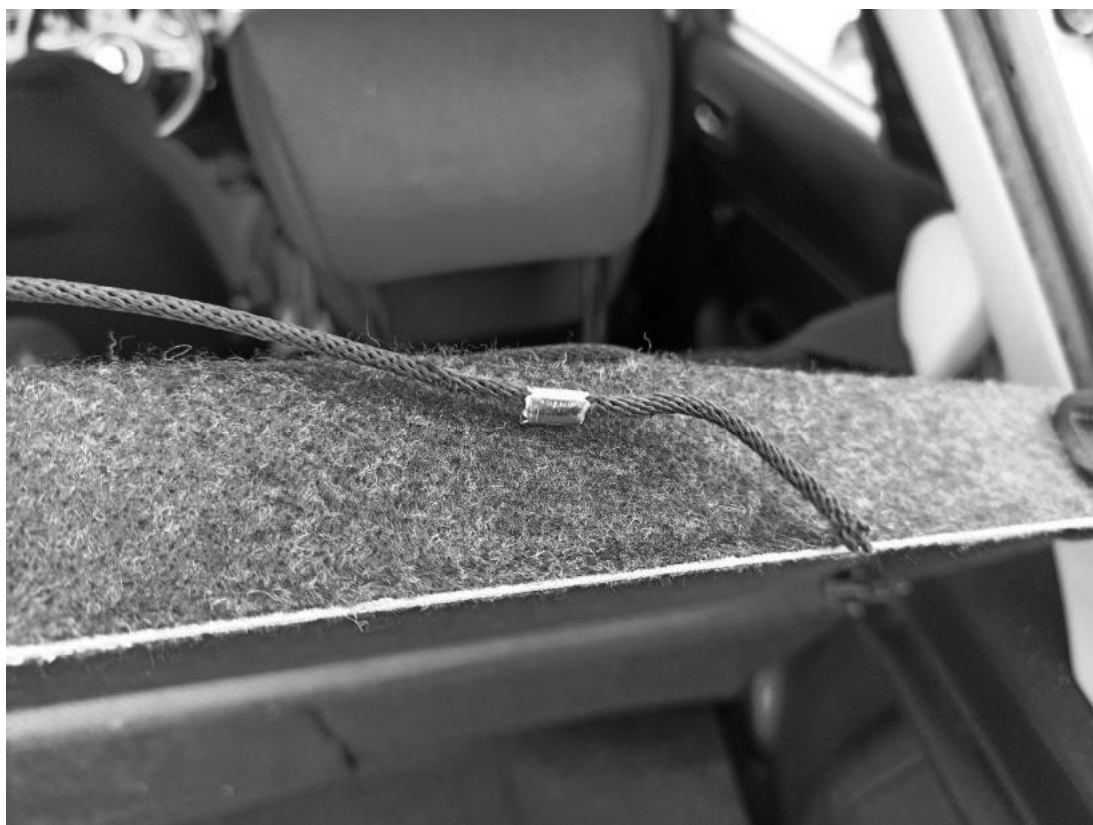
Fot. 46 Półka/roleta tylna - Pęknięcie/rozerwanie 1
