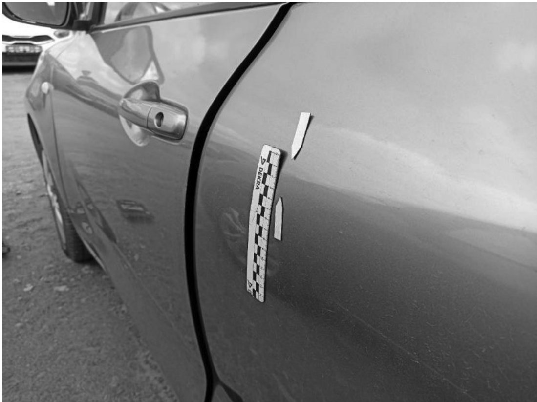
Fot. 39 Drzwi tylne L - Wgniecenie/odkształcenie 1
