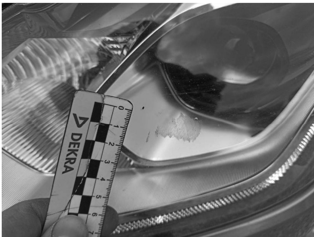
Fot. 51 Reflektor L - Rysa/odprysk 1
