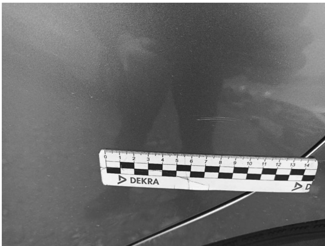
Fot. 48 Drzwi tylne L - Rysa/odprysk 1
