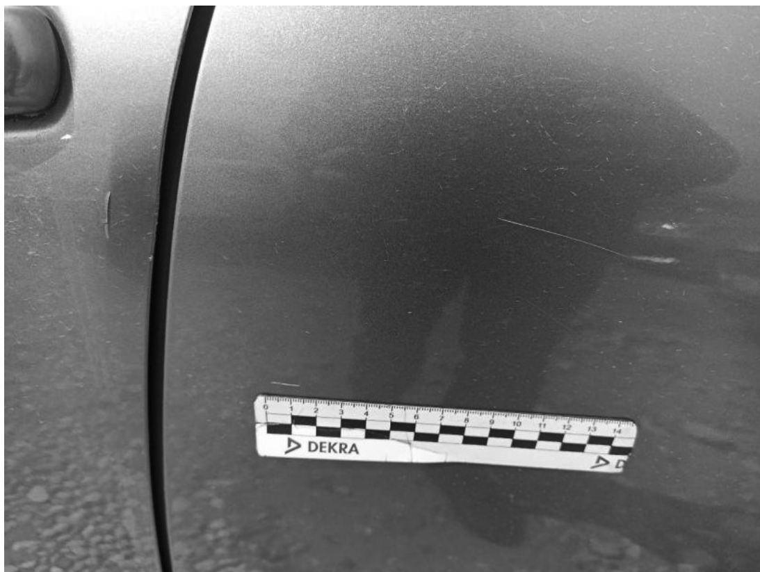
Fot. 49 Drzwi tylne L - Rysa/odprysk 2
