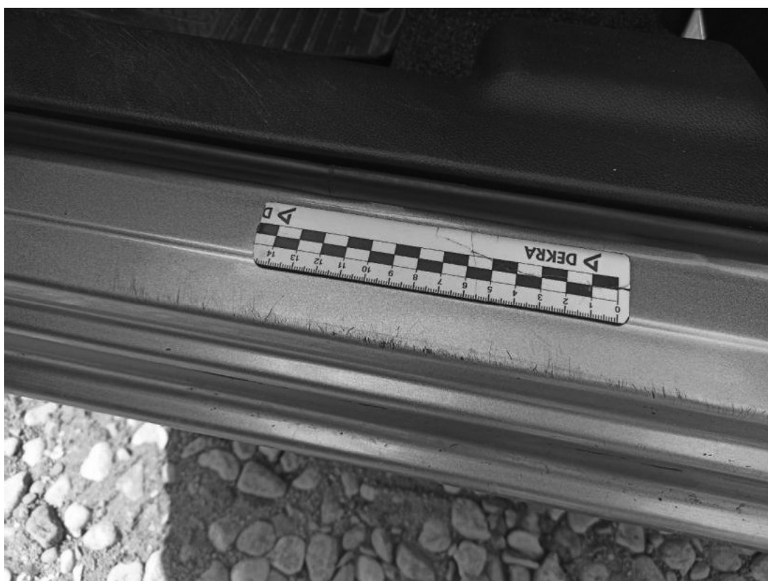
Fot. 50 Próg L - Rysa/odprysk 1
