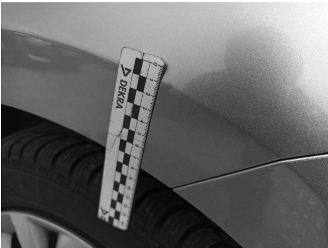
Fot. 33 Błotnik przedni P - Wgniecenie/odkształcenie 1
