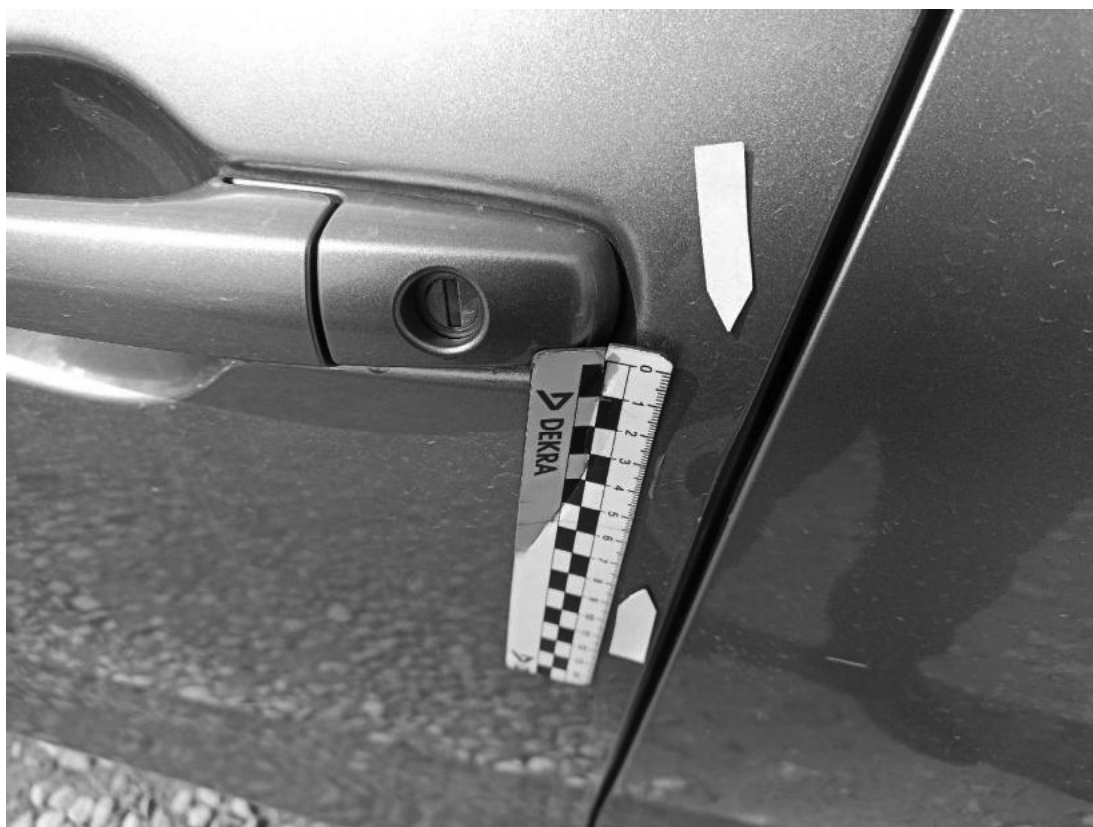
Fot. 46 Drzwi przed L - Wgniecenie/odkształcenie 1
