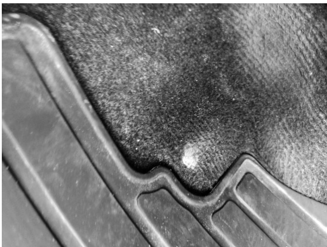
Fot. 52 Wykładzina podłogi - Pęknięcie/rozerwanie 1
