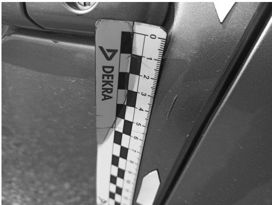
Fot. 47 Drzwi przed L - Pęknięcie/rozerwanie 1
