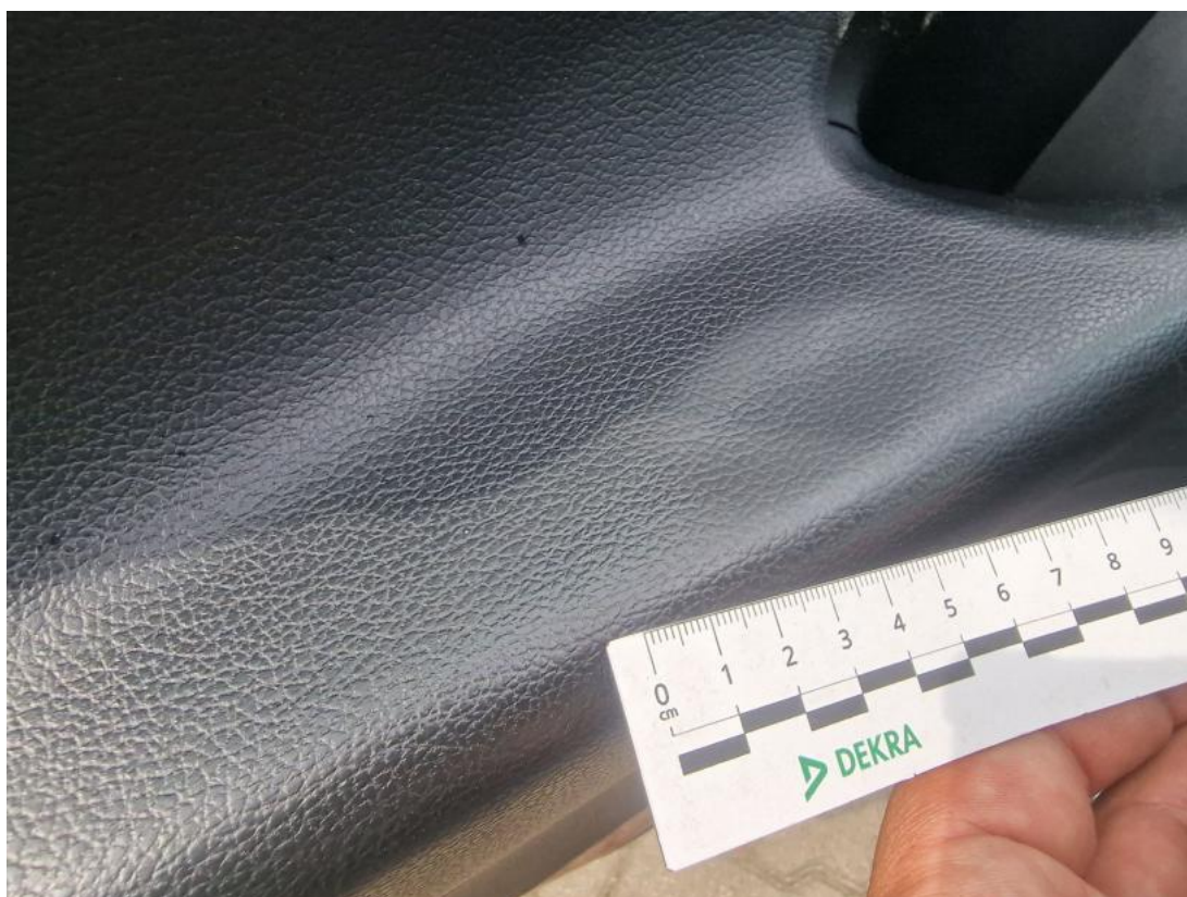
Fot. 45 Tapicerka drzwi przednich L - Wgniecenie/odkształcenie 1
