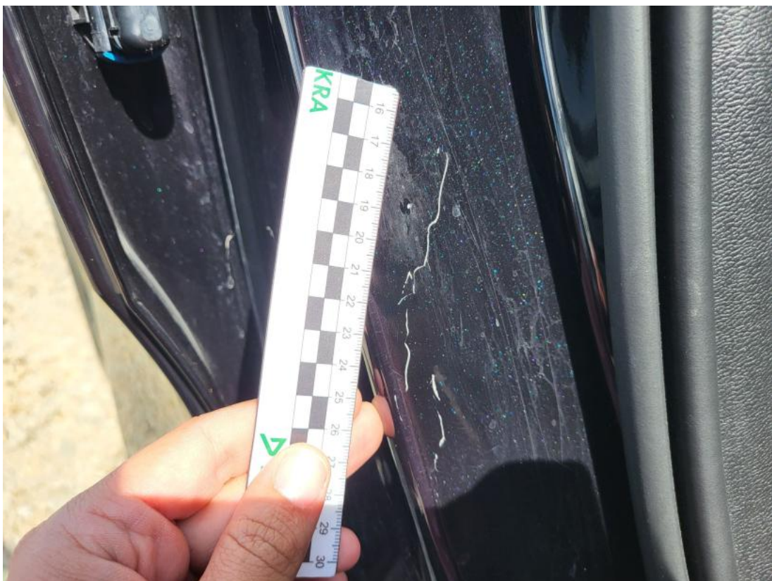
Fot. 40 Słupek środkowy P - Rysa/odprysk 1
