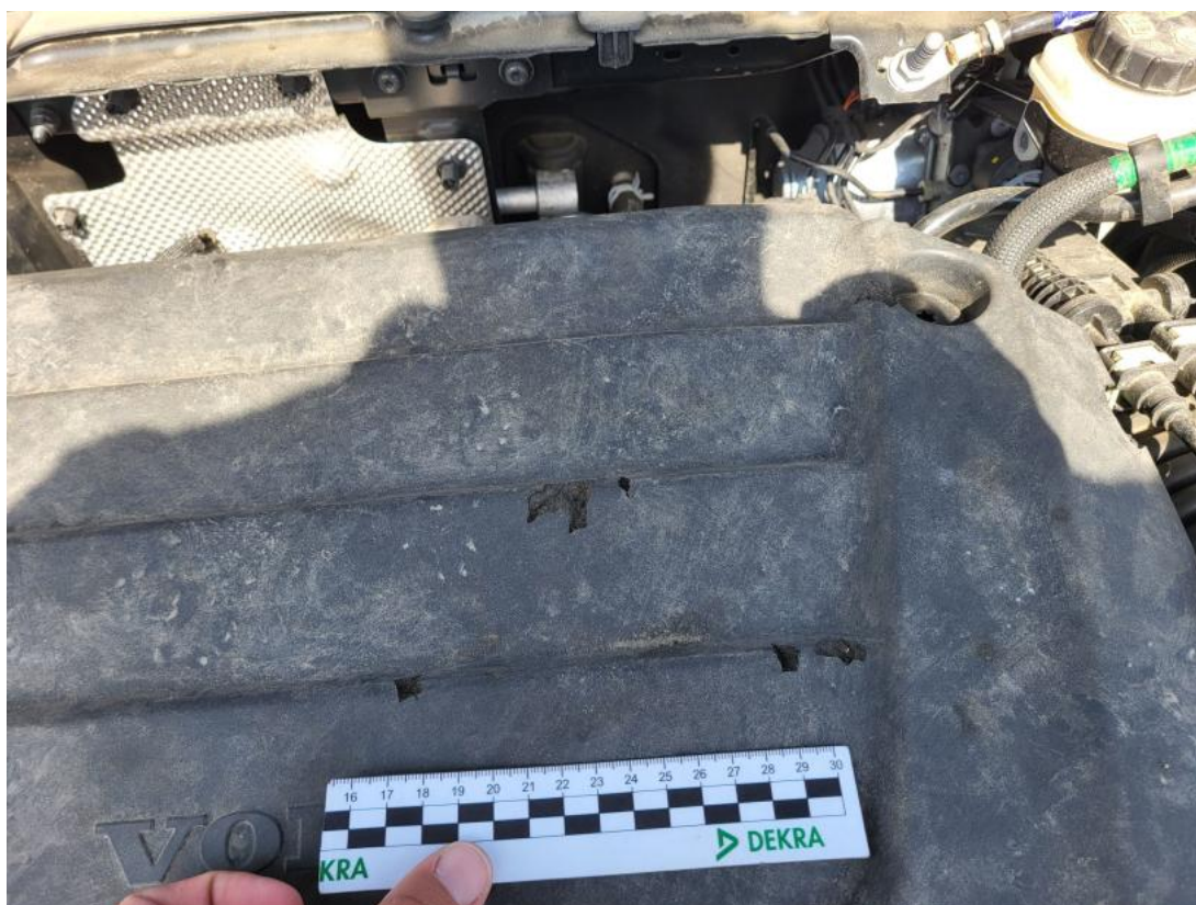
Fot. 38 Osłona dolna silnika - Pęknięcie/rozerwanie 1
