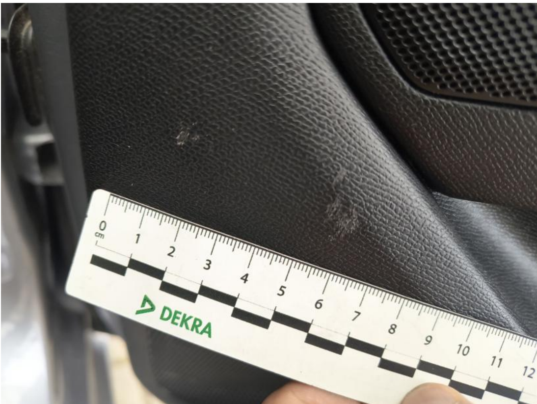
Fot. 62 Tapicerka drzwi tylnych P - Rysa/odprysk 1
