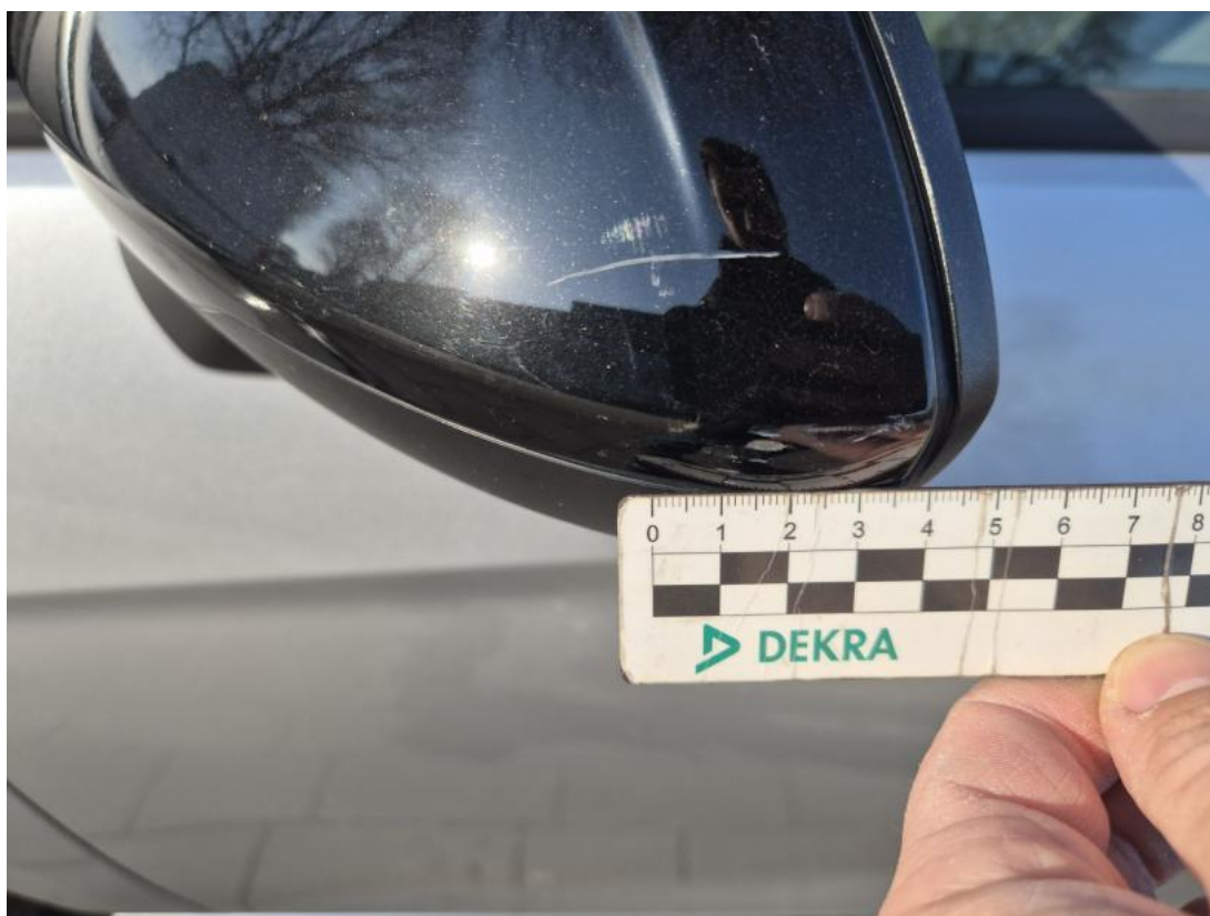
Fot. 43 Obudowa lusterka zew L - Rysa/odprysk 1
