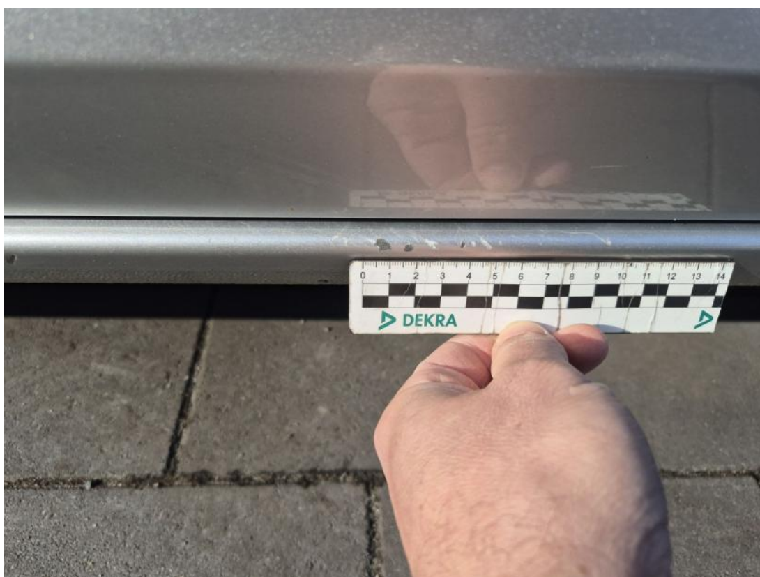
Fot. 44 Próg L - Rysa/odprysk 1
