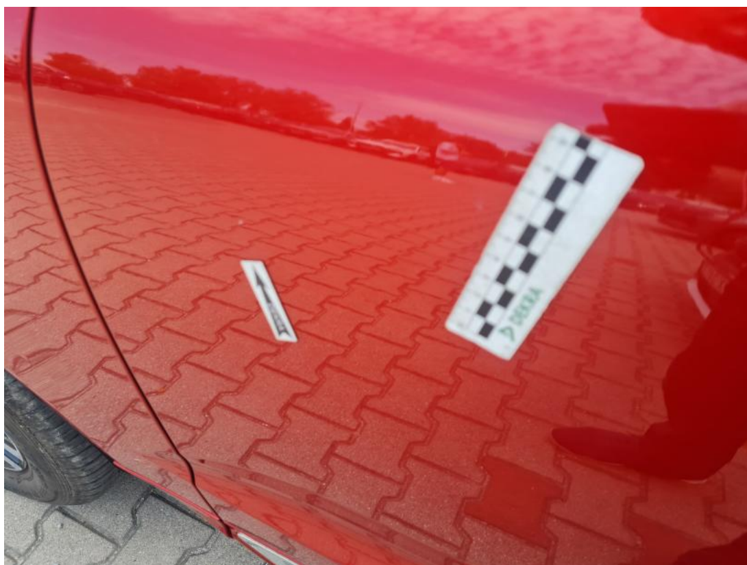
Fot. 48 Drzwi przed L() - Rysa/odprysk 3
