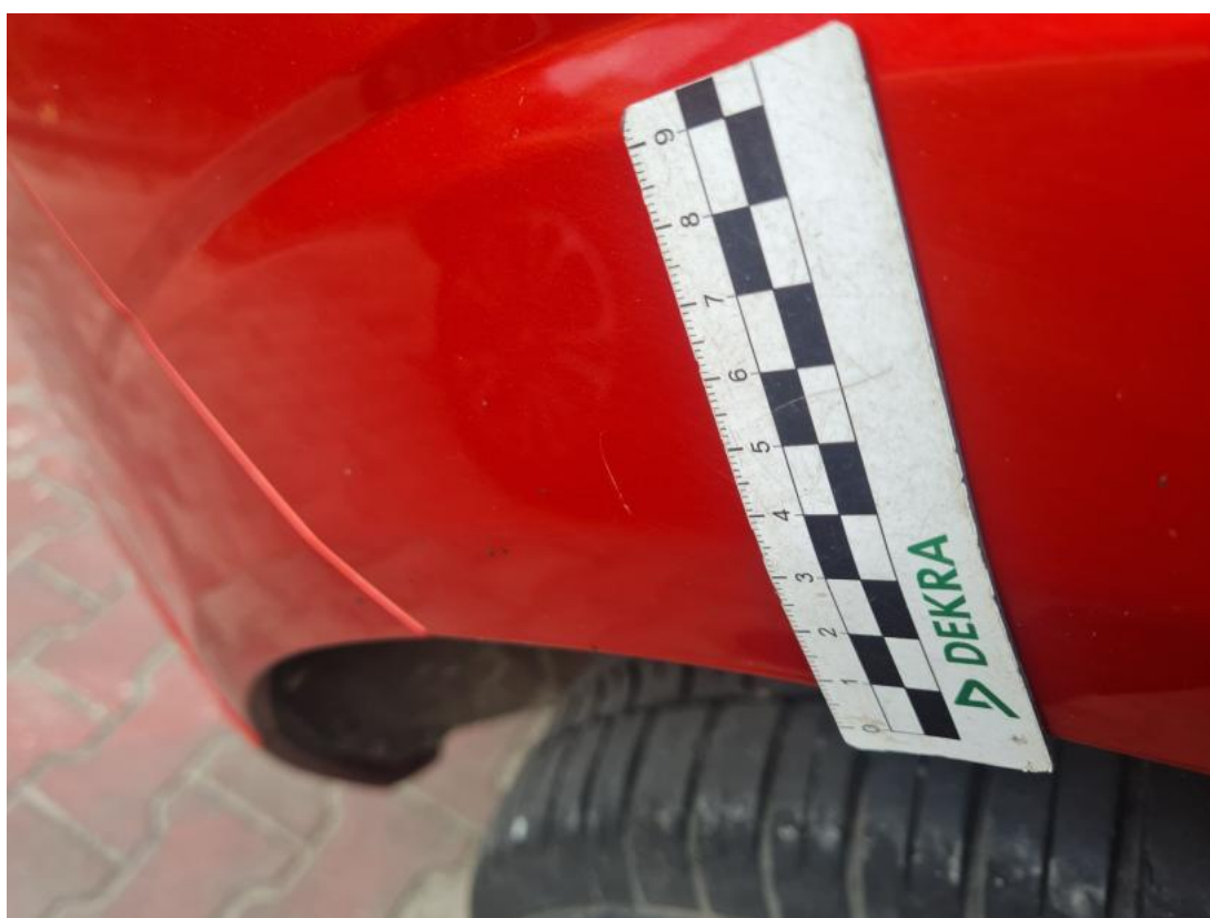
Fot. 46 Błotnik tylny P / Ściana boczna P - Rysa/odprysk 1
