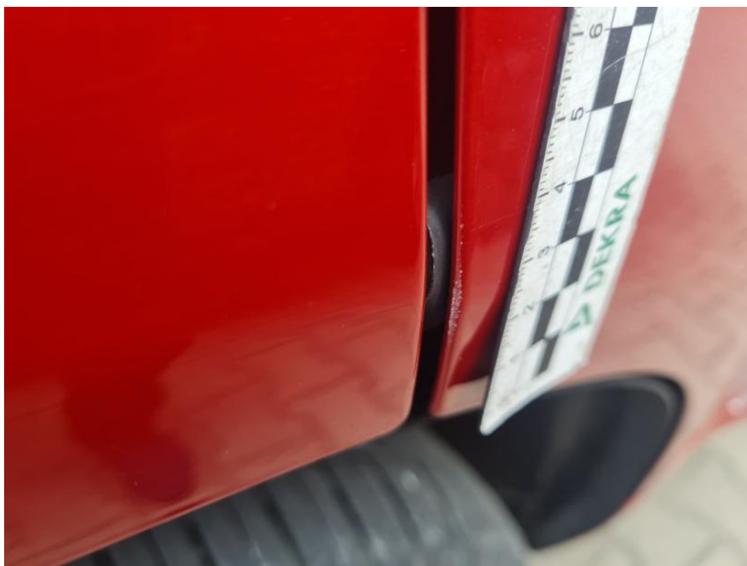
Fot. 45 Drzwi tylne P() - Rysa/odprysk 3
