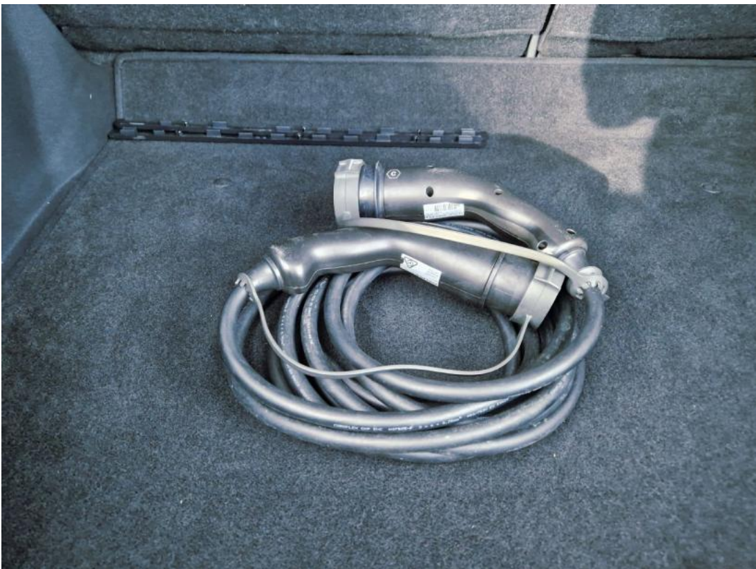
Fot. 28 Przewód ładowania baterii trakcyjnej
