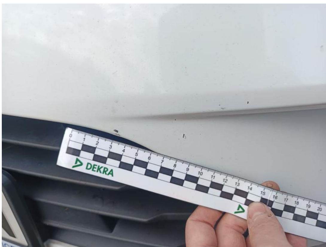
Fot. 42 Zderzak() - Rysa/odprysk 3
